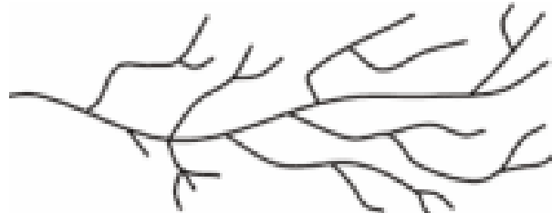
Figura 1 - Representação esquemática da estrutura molecular do PEBD
