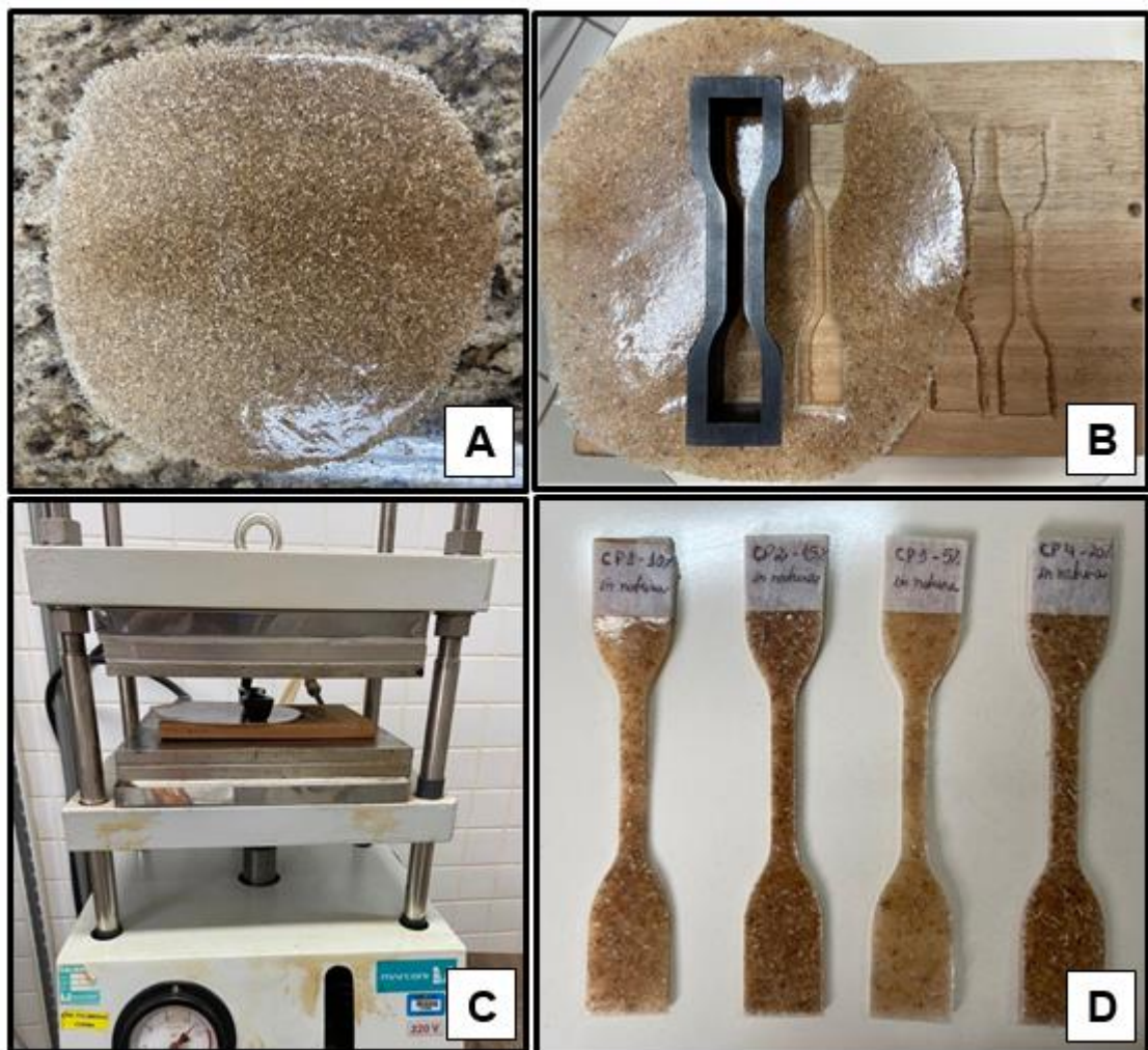
Figura 21 - Produção dos corpos de prova. (A) Placa de compósito PEBD reforçado com fibras de cana-de-açúcar; (B) Placa com cunha para retirar o corpo de prova; (C) Retirando corpo de prova com a cunha na prensa; (D) Corpos de prova
