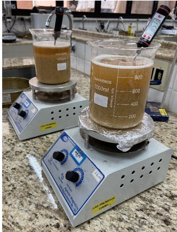
Figura 14 - Processo de extração do açúcar da fibra e outros resíduos
