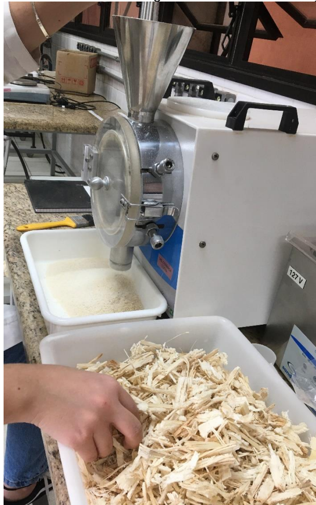
Figura 23 - Processo de moagem da fibra de cana-de-açúcar
