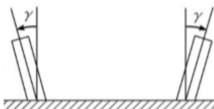
Figura 8: Ângulo de Camber Positivo
