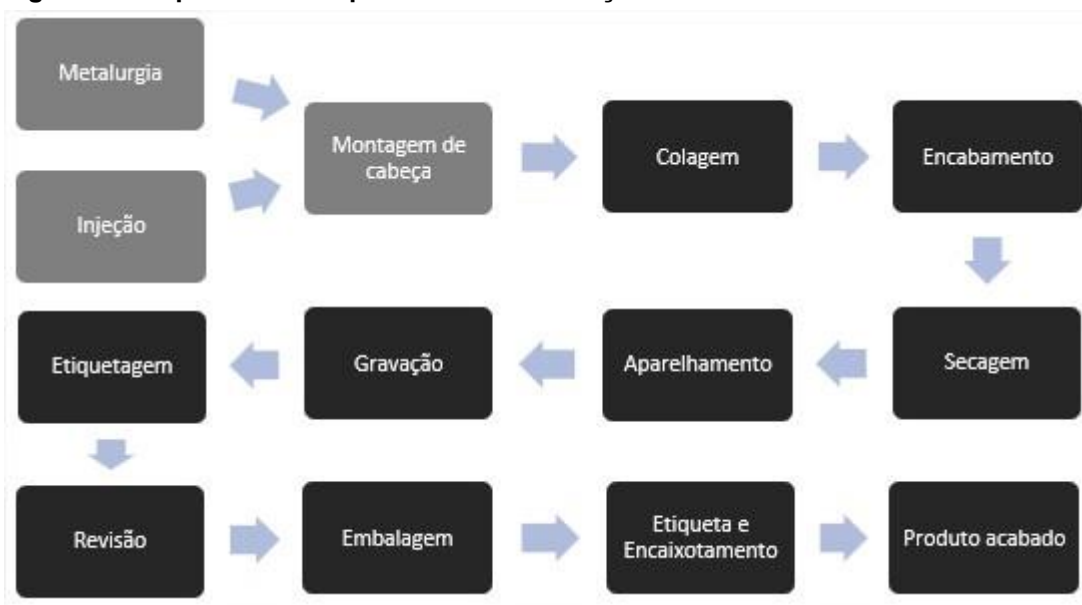
Figura 4 - Mapeamento do processo de fabricação das trinchas
