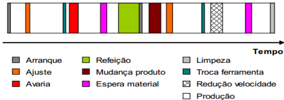
Figura 4 - A realidade do funcionamento de muitos equipamentos.
