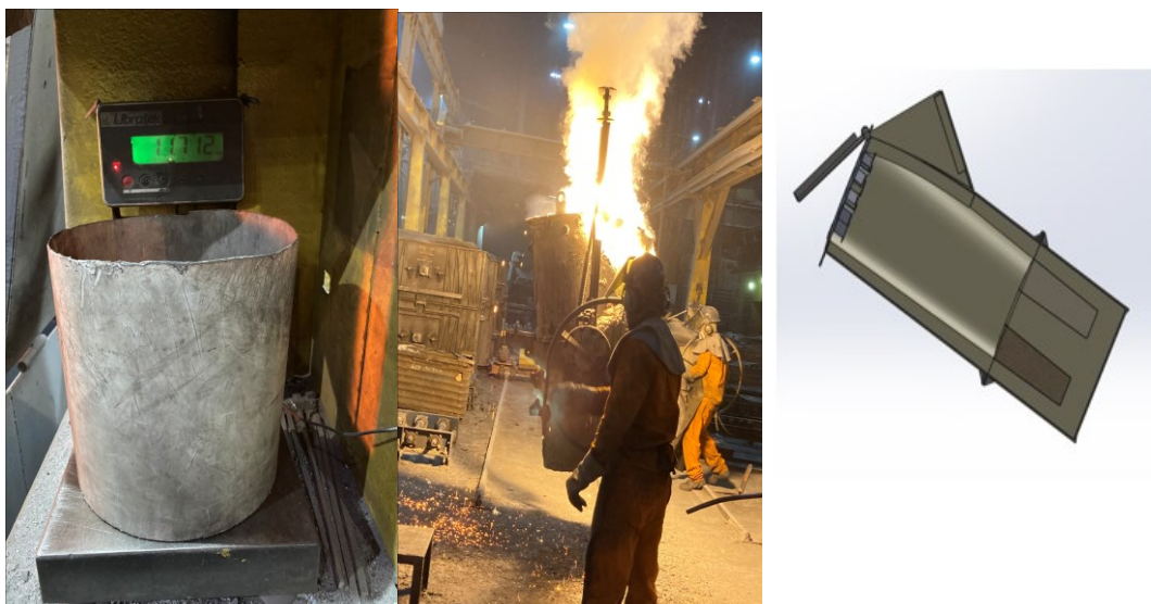
Figura 09 – Pesagem da liga de Mg e Reação de Nodularização
