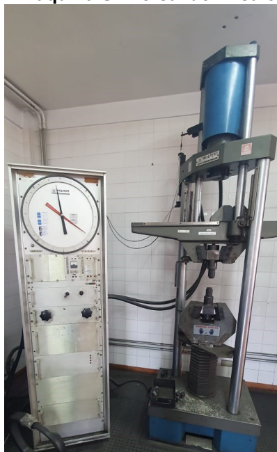
Figura 13 – Máquina Universal de Ensaio de Tração
