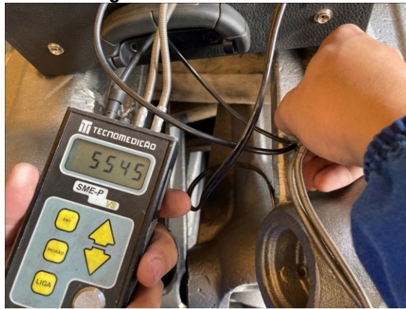
Figura 17 – Ensaio de Ultrassom
