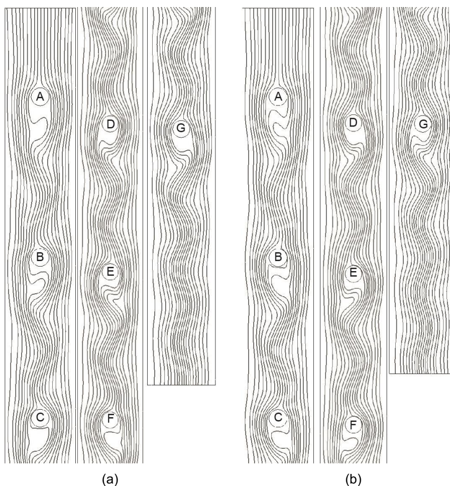
Figura 38 - Linhas de corrente para vazão volumétrica de 1 L/min: (a) 10 minutos iniciais e (b) 5 minutos finais
