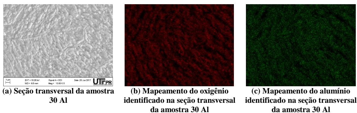
Figura 4.25 - Mapeamentos dos elementos identificados na seção transversal da amostra 30 Al
