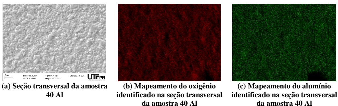
Figura 4.27 - Mapeamentos dos elementos identificados na seção transversal da amostra 40 Al
