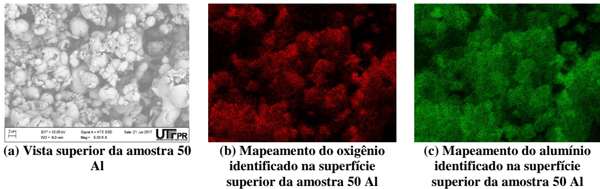
Figura 4.33 - Mapeamentos dos elementos identificados na vista superior da amostra 50 Al
