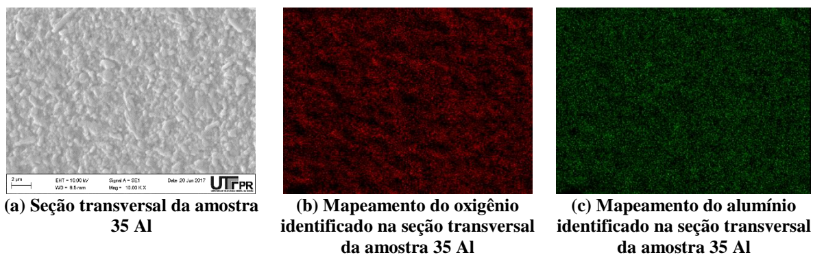
Figura 4.26 – Mapeamentos dos elementos identificados na seção transversal da amostra 35 Al
