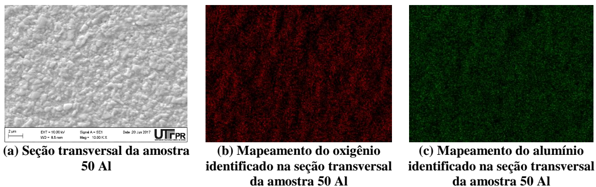
Figura 4.28 – Mapeamentos dos elementos identificados na seção transversal da amostra 50 Al
