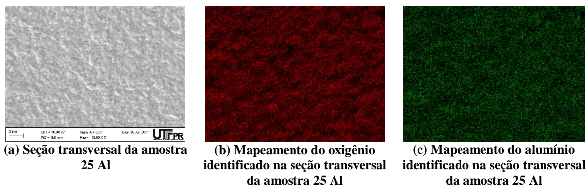
Figura 4.24 – Mapeamentos dos elementos identificados na seção transversal da amostra 25 Al
