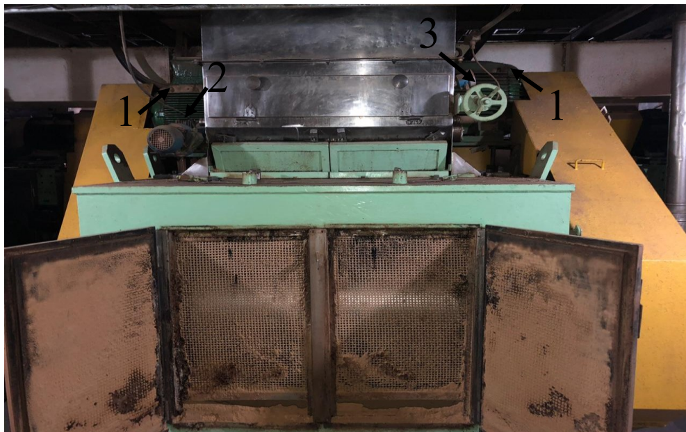
Figura 4 – Laminador de soja e seus principais componentes
