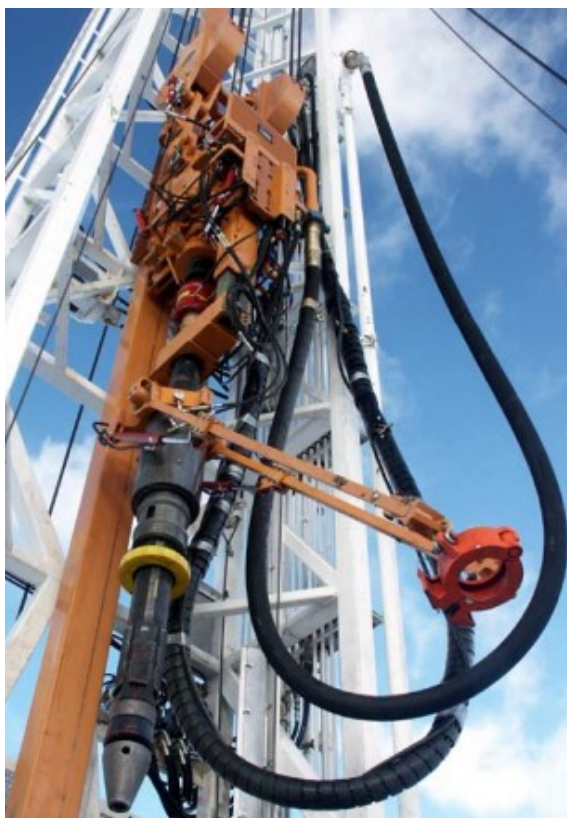
Figura 7 - Motor acoplado ao topo da coluna de perfuração
