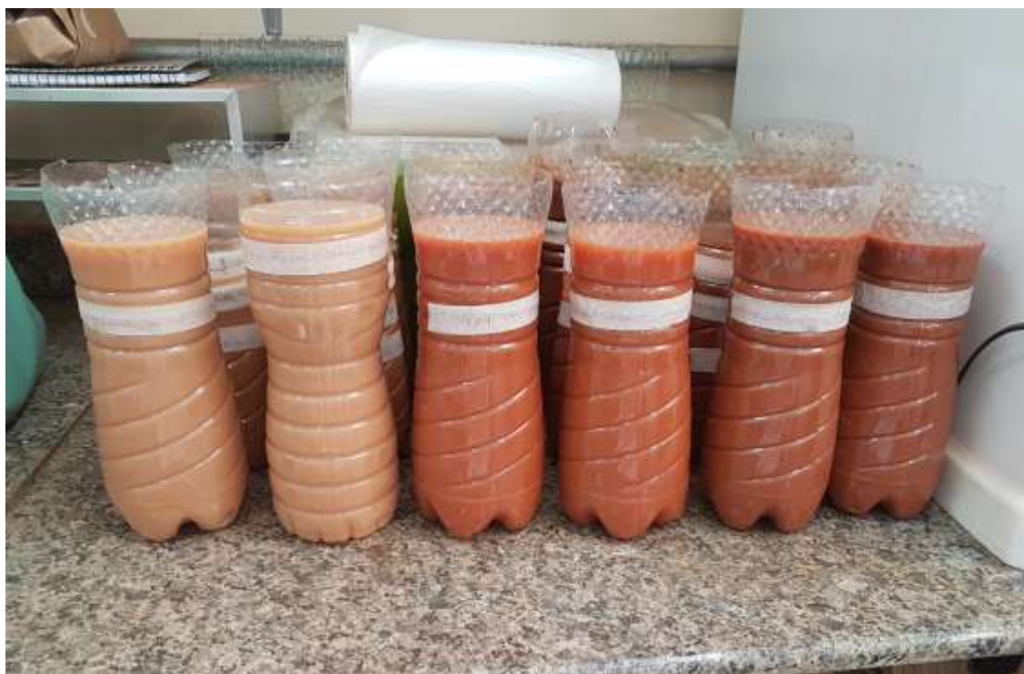
Figura 5 – Garrafas PET com solo para obtenção da fração argila
