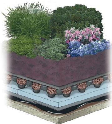
Figura 4 – Exemplo de telhado verde intensivo
