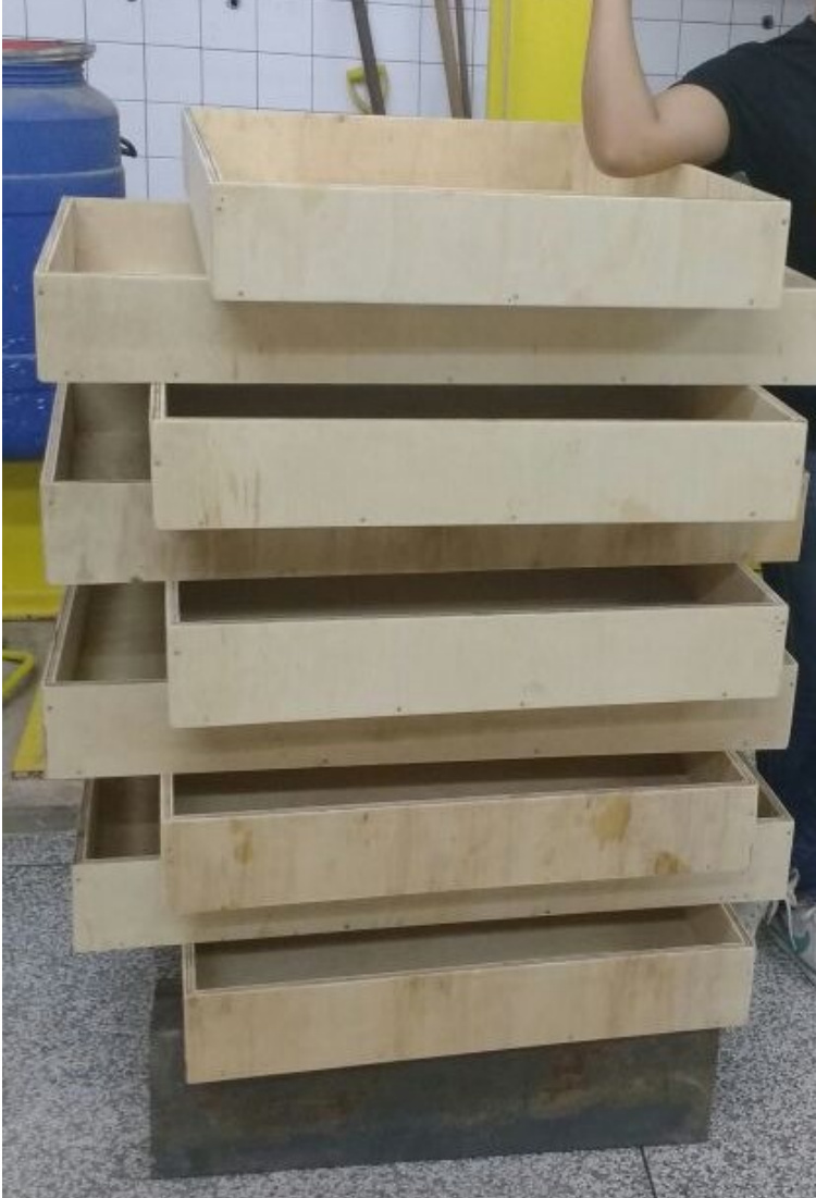
Figura 9 – Caixaote de madeira para montagem dos módulos do telhado verde
