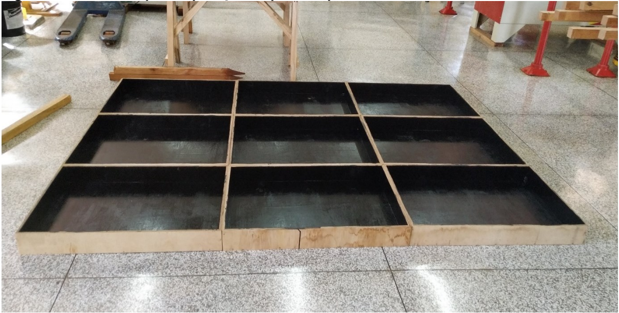
Figura 10 – Caixotes após a aplicação do prime impermeabilizante
