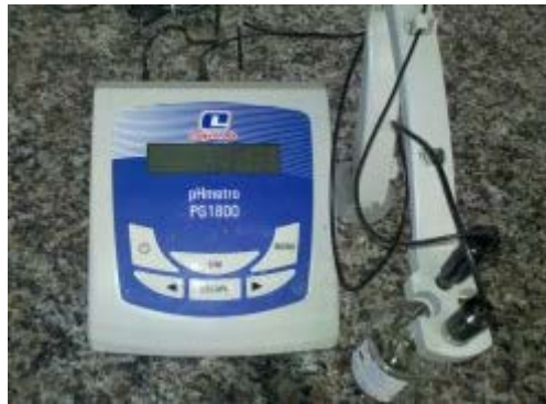
FOTOGRAFIA 1 – Exemplo de pHmetro utilizado para medição da atividade iônica do hidrogênio ( H^+ ).
