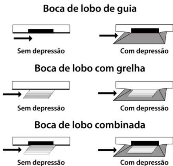
Figura 2 - Boca de lobo.
