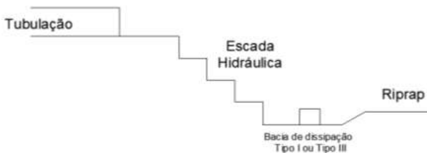
Figura 7 - Esquema em corte lateral do dissipador de energia do tipo escada hidráulica com Bacia de dissipação do Tipo I ou II.
