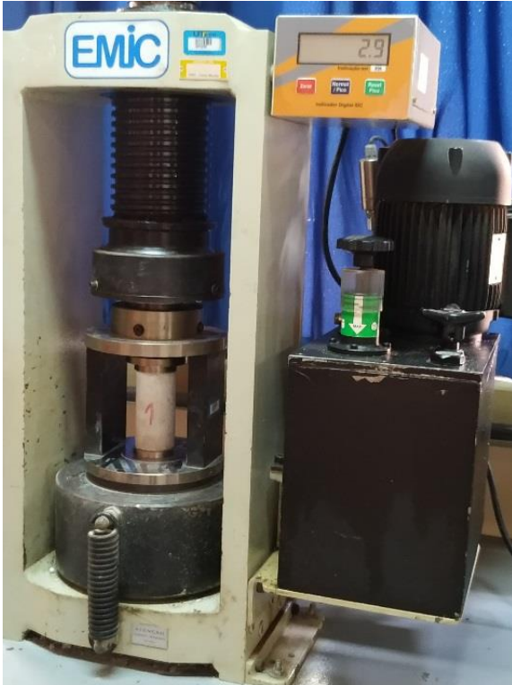
Figura 16 – Ensaio de resistência à compressão axial
