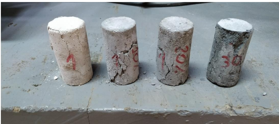
Figura 17 – Corpos de prova após o rompimento
