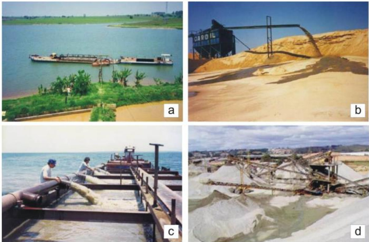
Figura 6 – Sistema de mineração da areia extraída de rios: (a) e (b) barcaça extraíndo a areia; (c) silo de estocagem de areia; e (d) separação e controle no areal.
