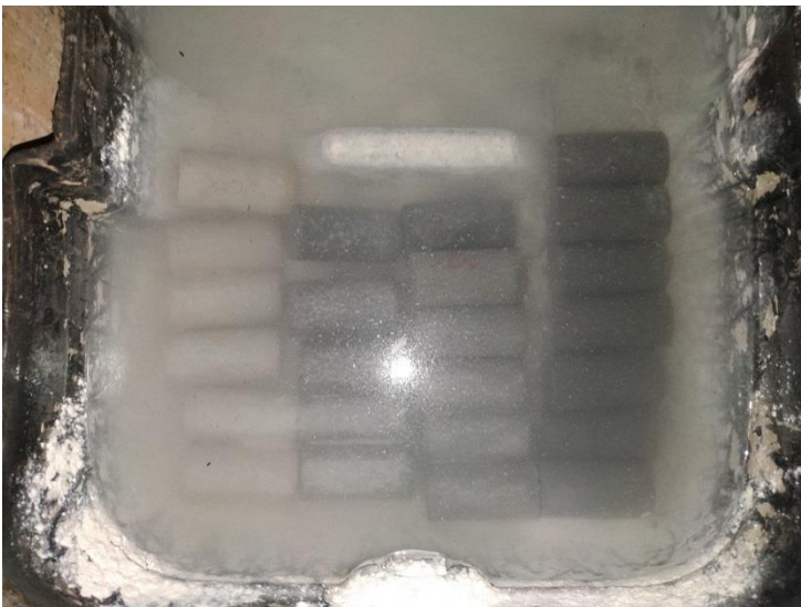
Figura 13 – Processo de cura
