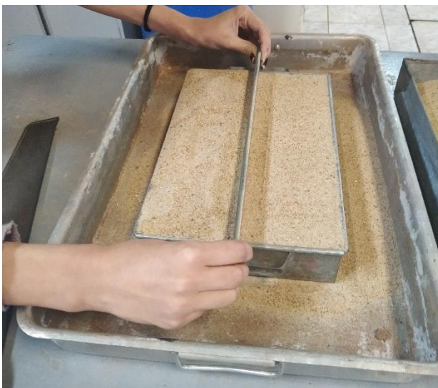
Figura 7 – Ensaio massa unitária da areia
