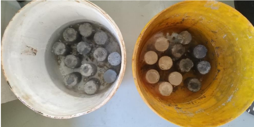
Figura 15 – Corpos de prova imersão total em água
