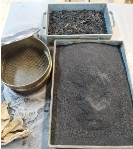
Figura 8 – Preparação da cinza para ensaios
