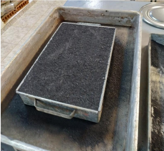
Figura 9 – Ensaio massa unitária da CBC
