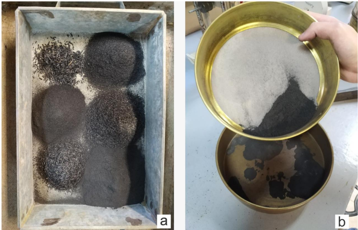
Figura 10 – Cinza retida nas peneiras de ensaio granulométrico
