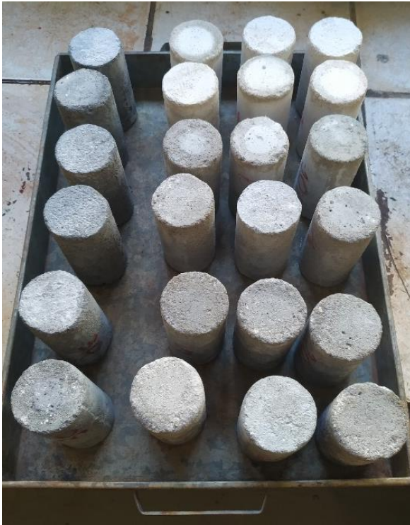
Figura 14 – Corpos de prova após 72h em estufa
