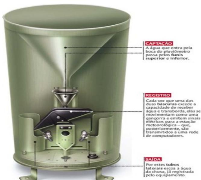
Figura 8 - Pluviômetro automático.
