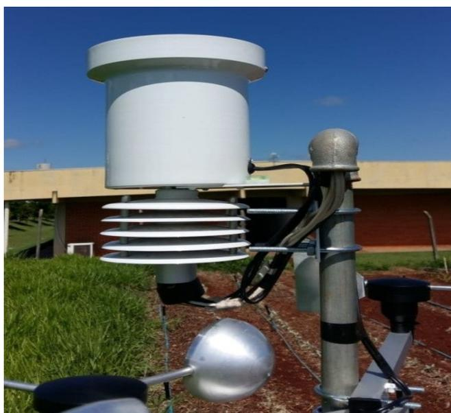
**Figura 26 – Pluviômetro para medir volume de chuva.**
