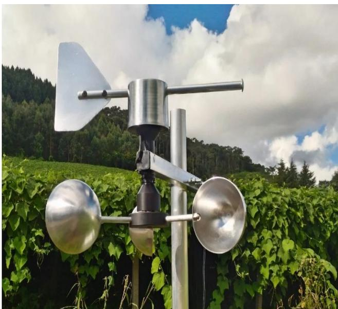
**Figura 9 - Anemômetro com biruta automático.**
