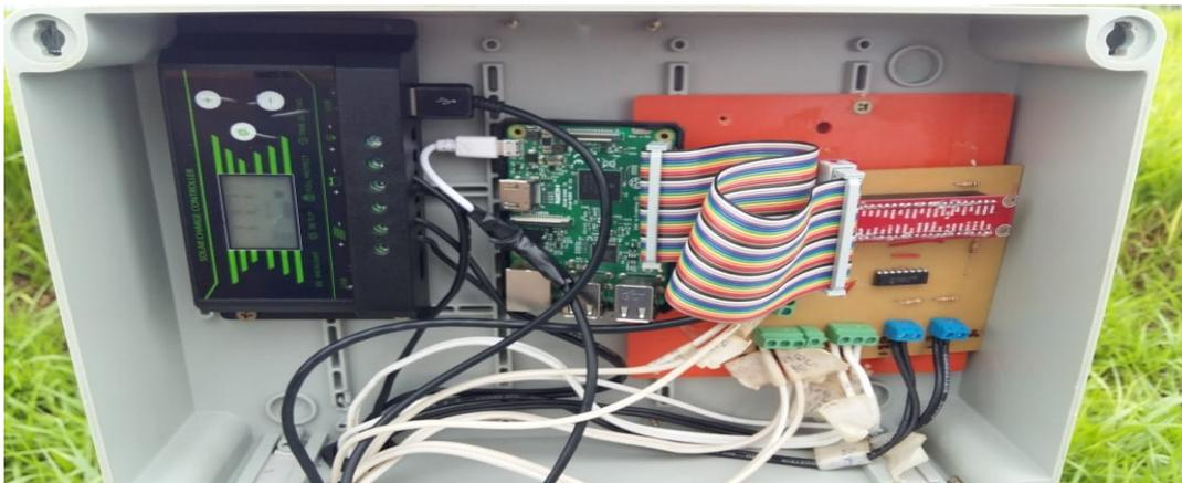
**Figura 33 – Conexões dos sensores ao Raspberry Pi®.**
