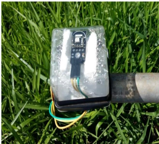
**Figura 31 – Sensor de radiação solar UV.**
