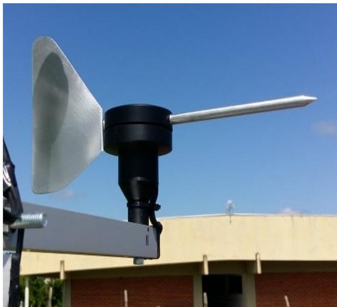
**Figura 28 – Anemoscópio para mediar a direção do vento.**
