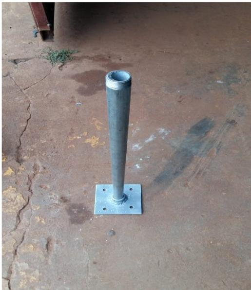
**Figura 22 – Tubo galvanizado de 70 cm rosqueado à base de concreto para fixação da placa metálica.**
