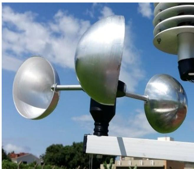
**Figura 27 – Anemômetro para medir a velocidade do vento.**
