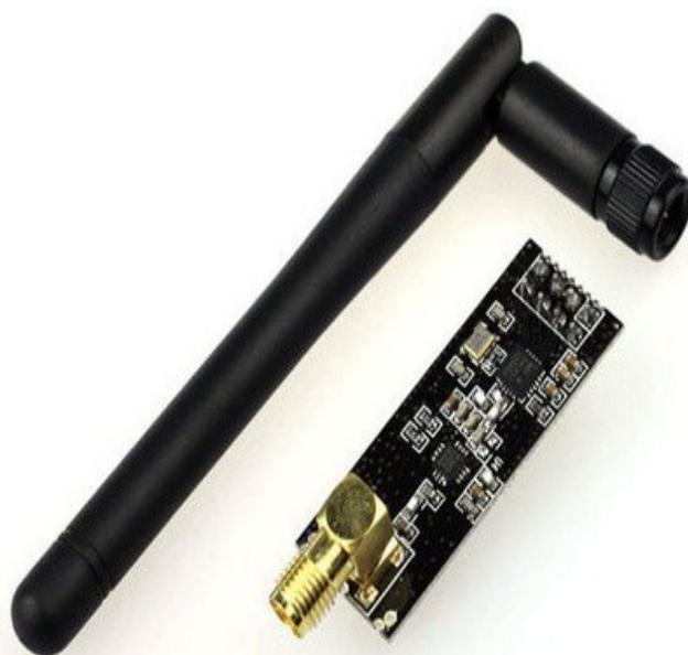
**Figura 15 - Ilustração de um módulo e antena wireless**
