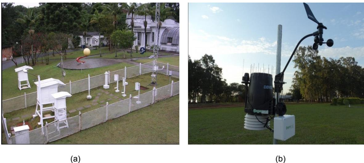
**Figura 3 – Tipos de estação meteorológica: convencional (a) e automática (b).**
