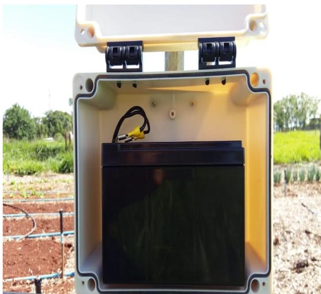
**Figura 29 – Bateria para armazenamento de energia para funcionamento dos sensores e demais aparelhos utilizados na estação meteorológica.**
