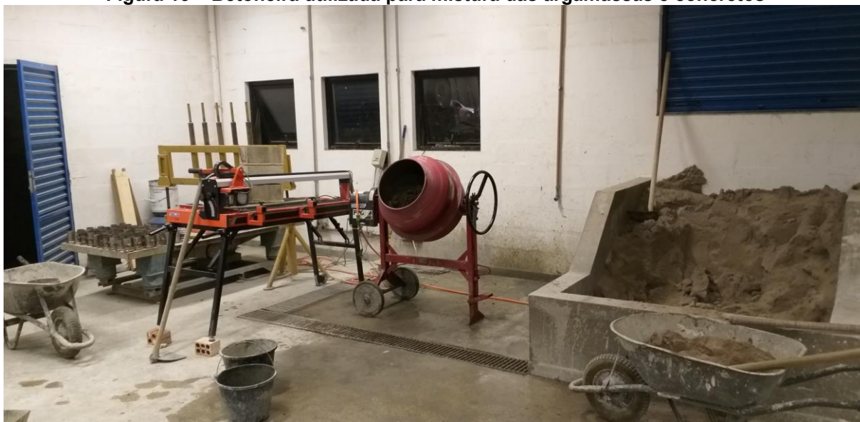
Figura 13 – Betoneira utilizada para mistura das argamassas e concretos
