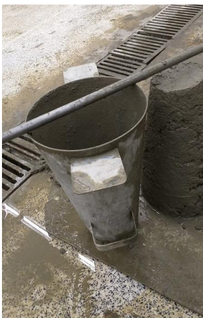
Figura 15 – Ensaio de abatimento do tronco de cone
