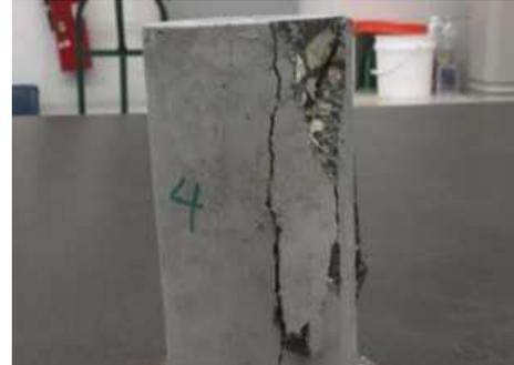
(b) Corpos de prova cilíndrico - Concreto convencional
