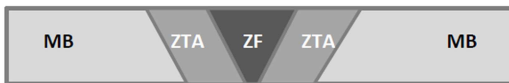
Figura 5 - Definições de uma junta soldada
