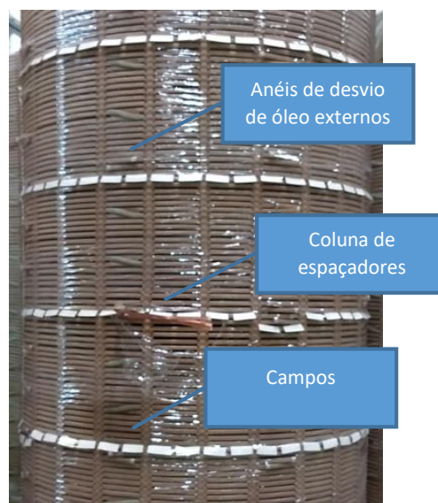
Figura 14: Bobina com anéis de desvio externos Fonte: O autor (2020).
