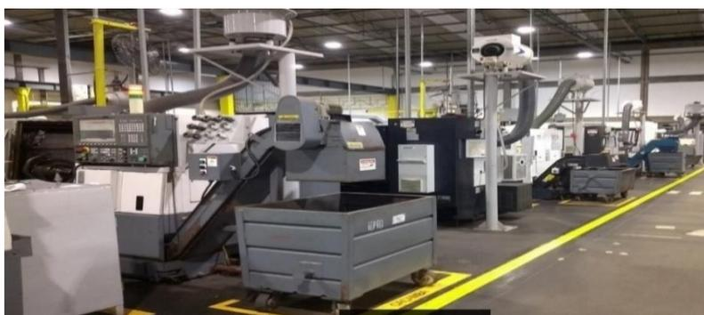
**Figura 7. Centros de torneamento CNC.**
