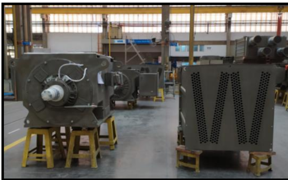
Figura 12 - Exemplo de máquina com trocador de calor desmontado para pintura Fonte: O Autor, 2020.
