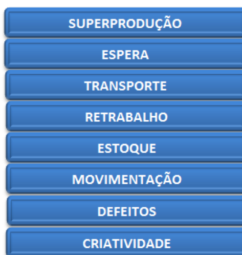
Figura 4 - Os oito desperdícios do Lean Manufacturing Fonte: Adaptado de Liker, 2005.
