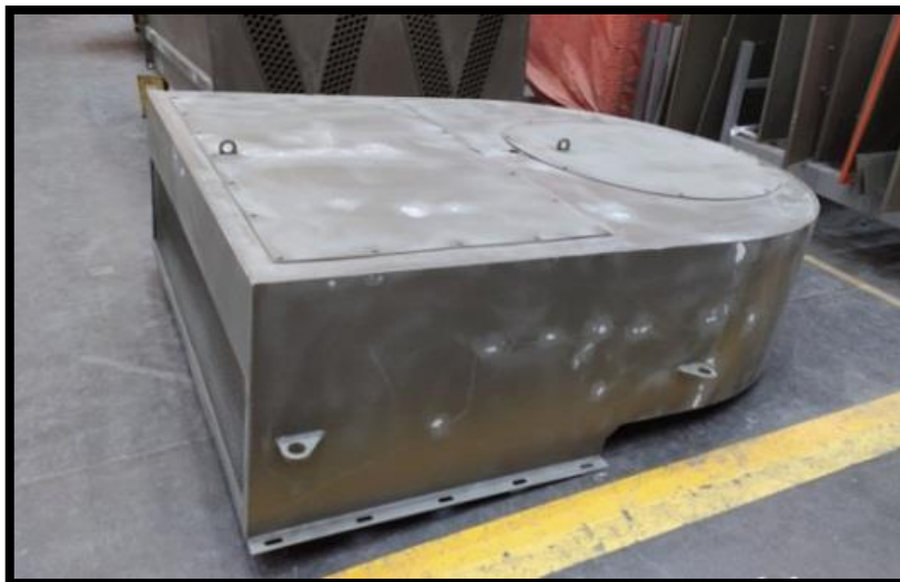
Figura 13 - Exemplo de atenuador desmontado para pintura Fonte: O Autor, 2020.
