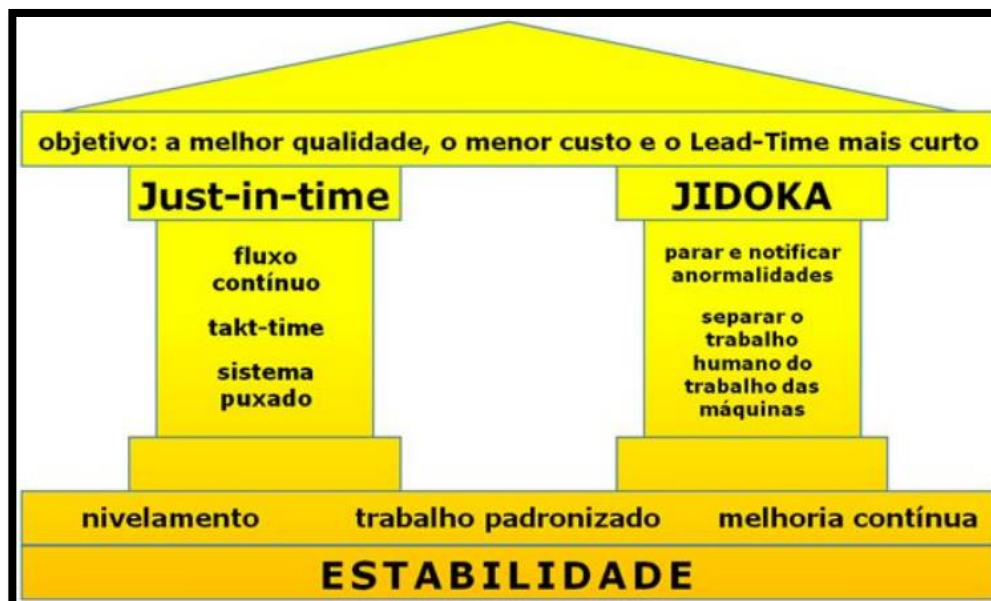
Figura 2 - Pilares do Sistema Toyota de Produção Fonte: Adaptado de Ohno, 1997.
