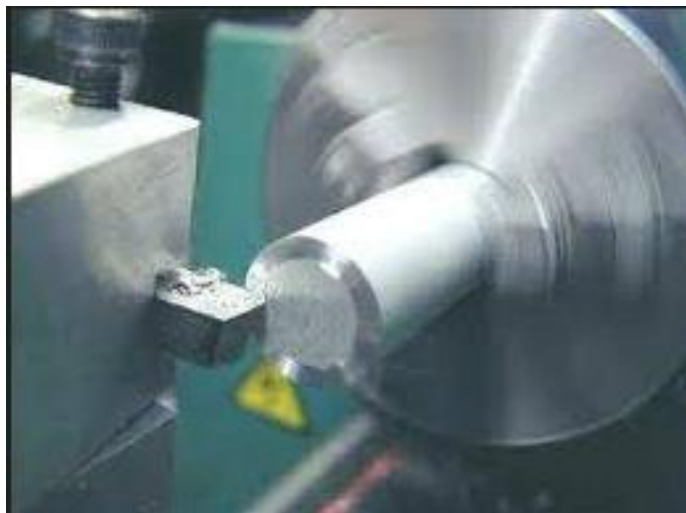
Figura 10 – Processo de facear. Fonte: O autor (2020).
