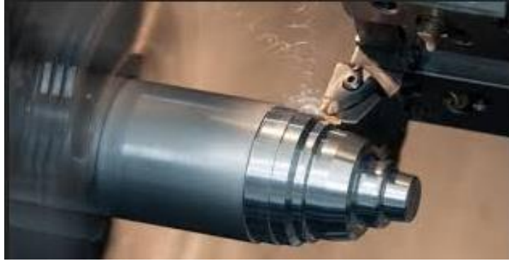
Figura 11 – Processo de tornear.
