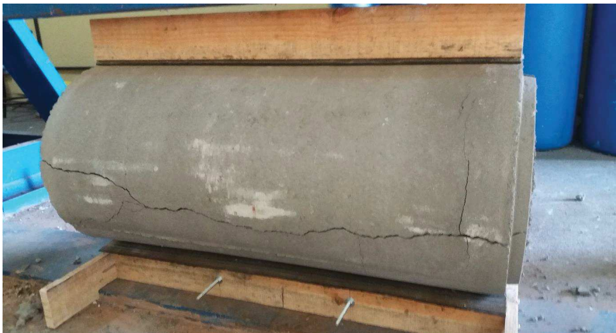
Figura 30 – Fissura lateral no corpo de prova após o ensaio de compressão diametral de CA3
