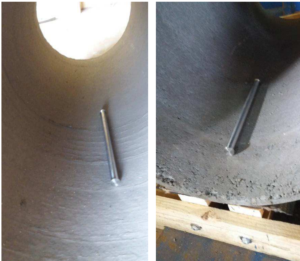
Figura 16 – Tubos CA1 e CA3 reprovados no teste do gabarito
