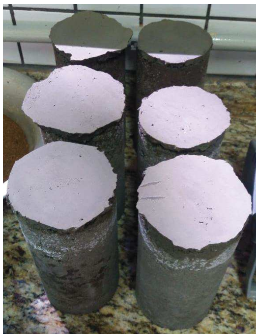
Figura 22 – Capeamento realizado nos corpos de prova cilíndricos
