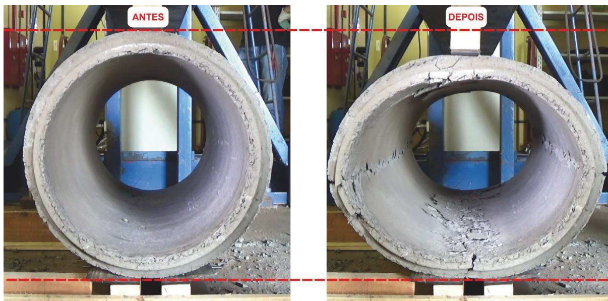
Figura 29 – Comparativo de antes e depois do ensaio de compressão diametral de CA3
