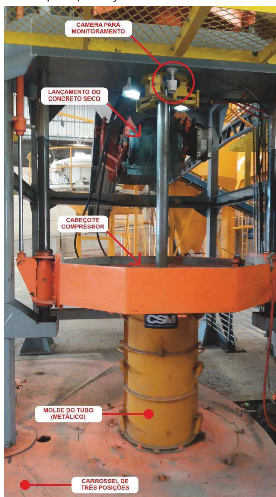
Figura 10 – Equipamento utilizado para produção de tubos de concreto
