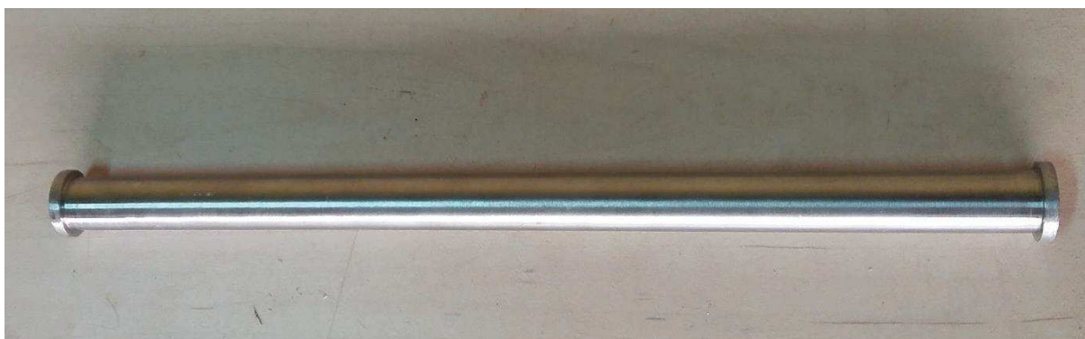
Figura 7 – Gabarito em aço inoxidável utilizado para avaliação de superfície interna dos tubos
