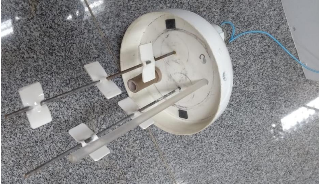
Figura 14 - Fotografia da tampa do tanque reacional inclinada.
