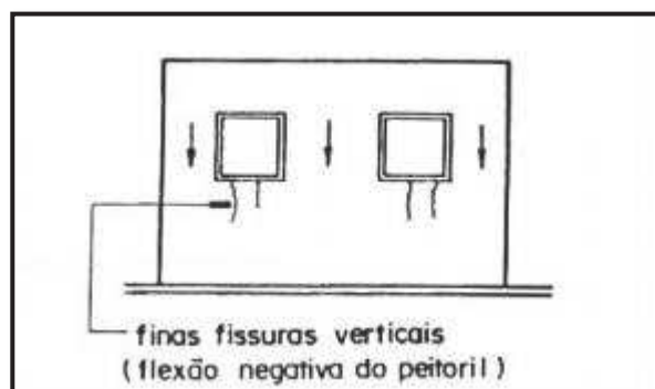
Figura 14 - Fissuras verticais sob peitoril da janela
