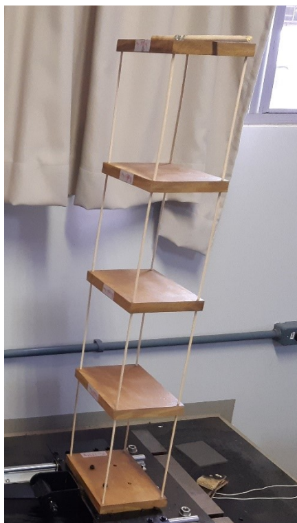
Figura 21 - Protótipo de um prédio
