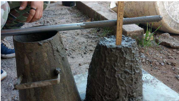
Figura 13 – Resultado do teste de abatimento.
