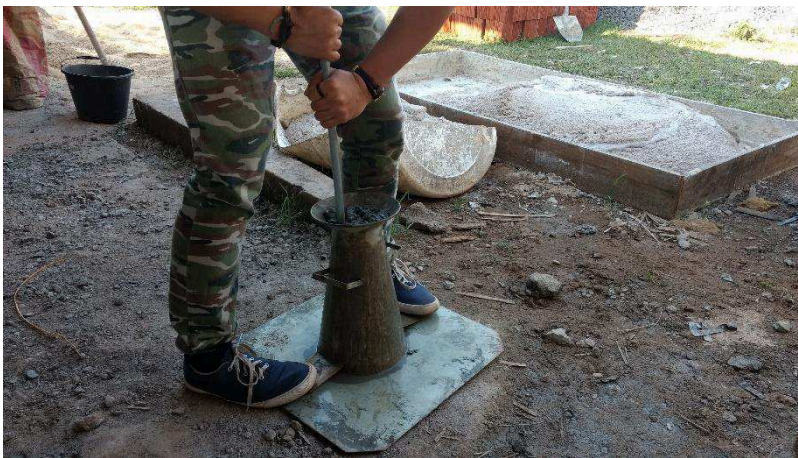
Figura 5 – Execução do teste de abatimento.
