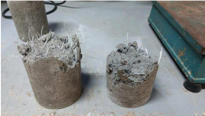
Figura 15 - Corpo de prova rompido com adição.
