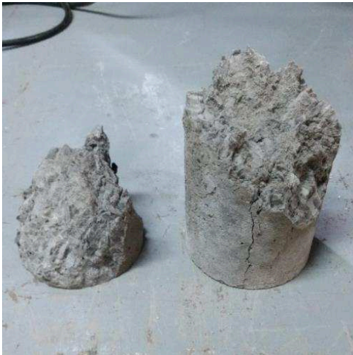
Figura 14 - Corpo de prova rompido sem adição.
