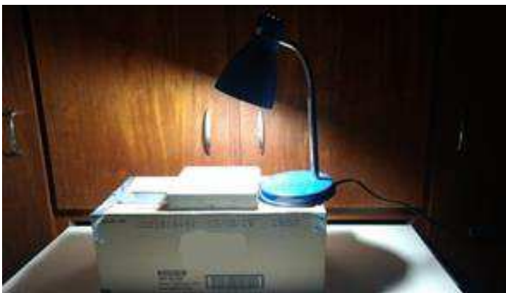
Figura 10 – Caixa escura para teste de translucidez com luz artificial.
