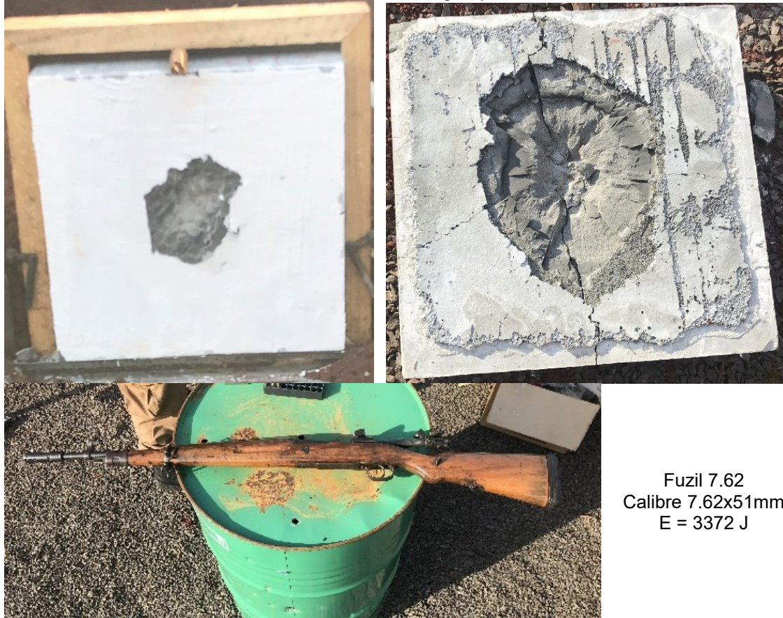
Figura 35: Amostra CF01+ (placa com adição de 60 kg/m 3 ).
