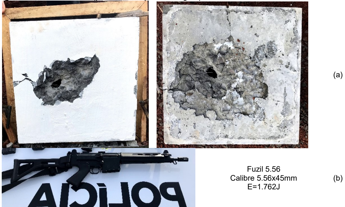
Figura 36: Amostra CF02+ (placa com adição de 60 kg/m 3 ).
