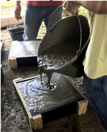
Figura 18: Moldagem das placas.
