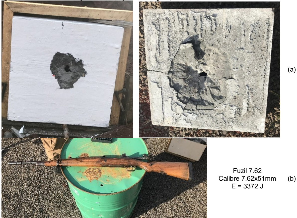
Figura 31: Amostra CF01- (placa com adição de 45 kg/m 3 ).
