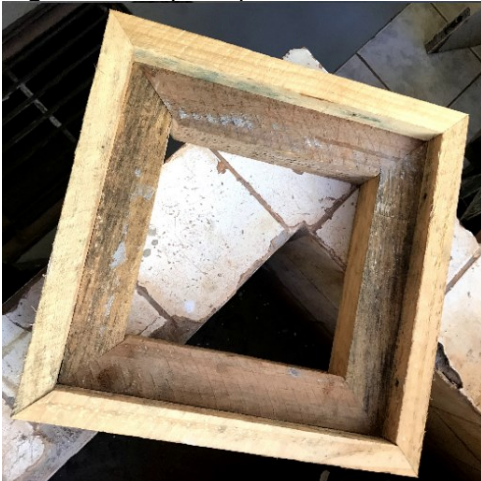
Figura 21: Suporte para o ensaio balístico nas placas de concreto.
