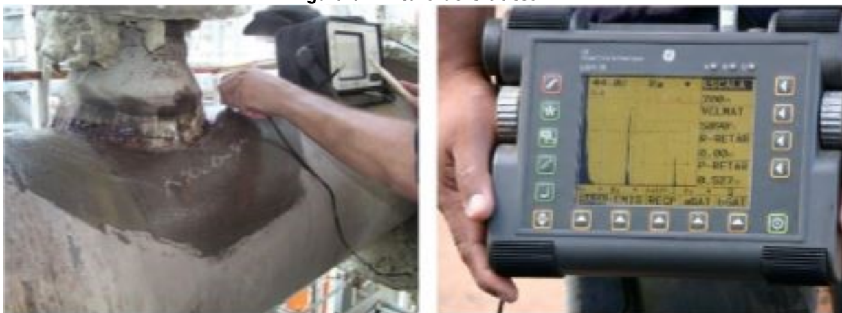
Figura 9 - Ensaio de Ultrassom
