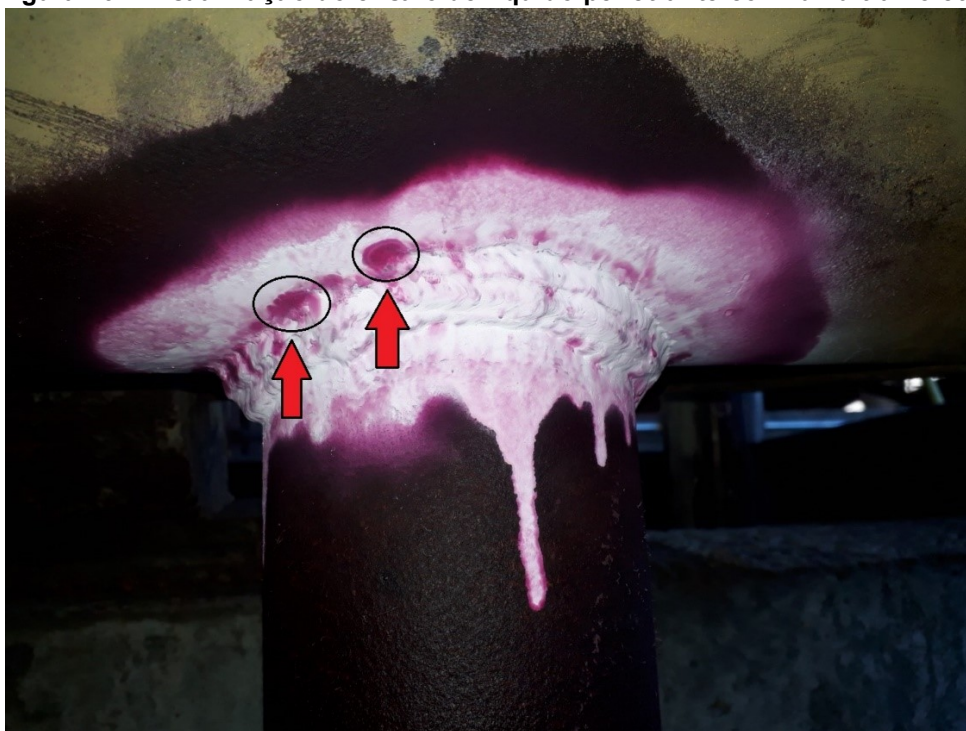
Figura 16 – Visualização do ensaio de líquido penetrante com luz ultravioleta
