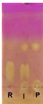
Figura 24 – Cromatografia por camada delgada do COL-N 3 (Autoria Própria, 2020). Revelador: solução de permanganato de potássio e efluente: hexano/acetato de etila ( v=0,75/0,25 ).
