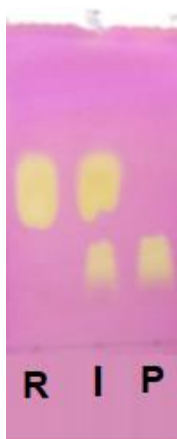
Figura 17 - Cromatografia por Camada Delgada do CHEMS (Autoria Própria, 2020). Revelador: solução de permanganato de potássio e efluente: hexano/acetato de etila (v=0,75/0,25).
