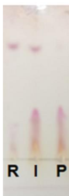
Figura 34– Imagem da CDD da reação (Autoria própria, 2020). Revelador: solução de ninidrina e eluente: metanol/diclorometano (v=0,05/0,95).
