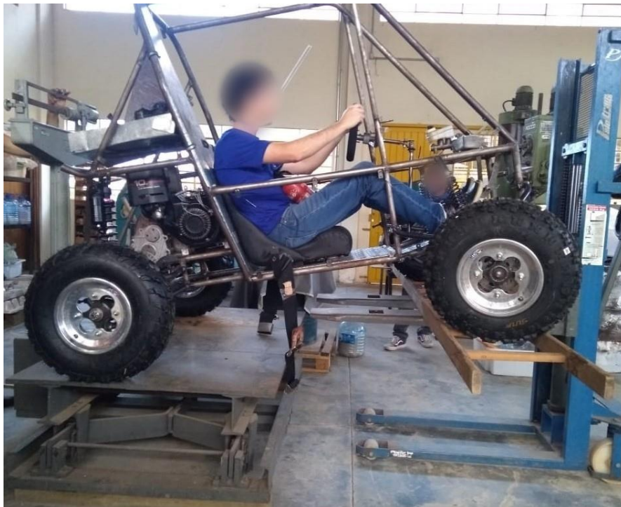
Fotografia 1 - Ensaio para obter o centro de gravidade do veículo
