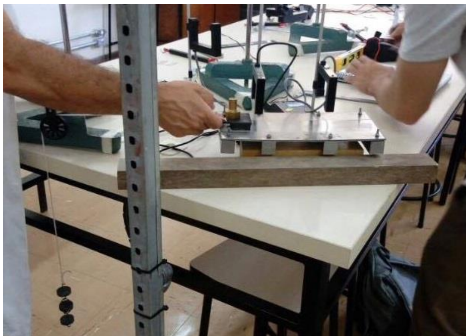
Fotografia 2 - Ensaio para obter o coeficiente de atrito entre pastilha e disco
