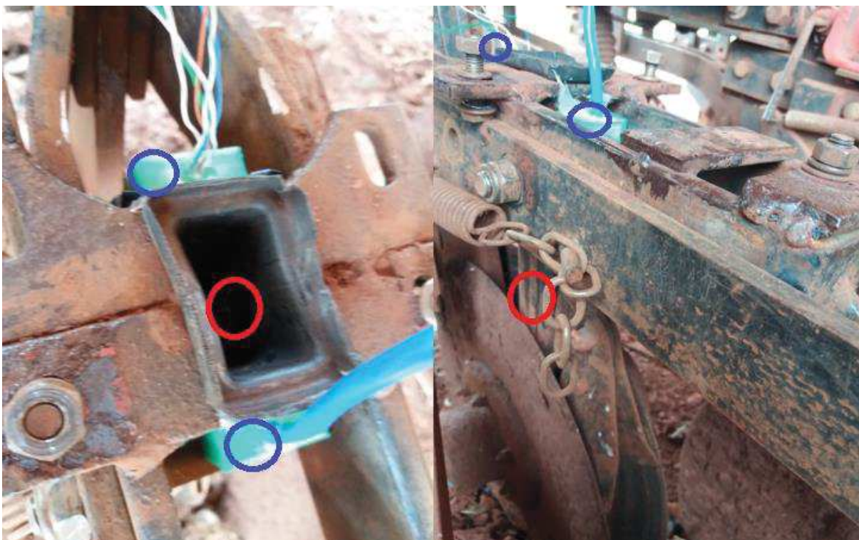
Figura 7: Disposição do sensor de semente na linha da semeadeira Fonte: Autoria própria
