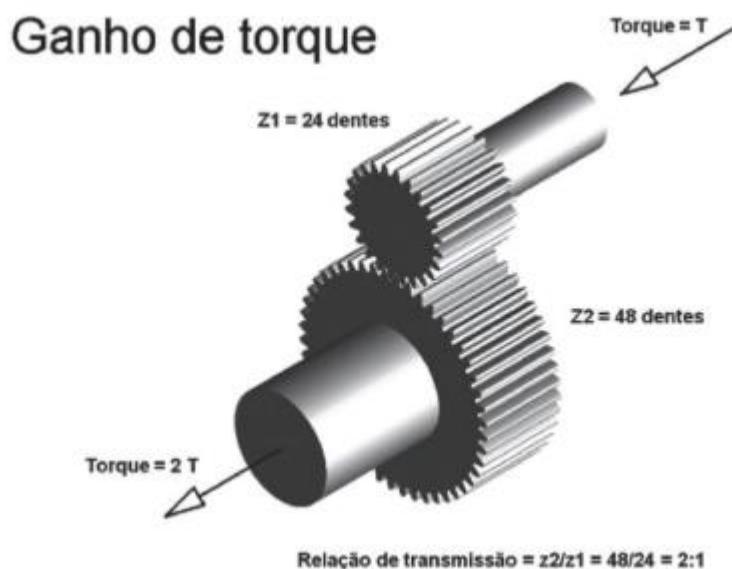
Figura 13 - Transmissão por engrenagens com ganho de torque
