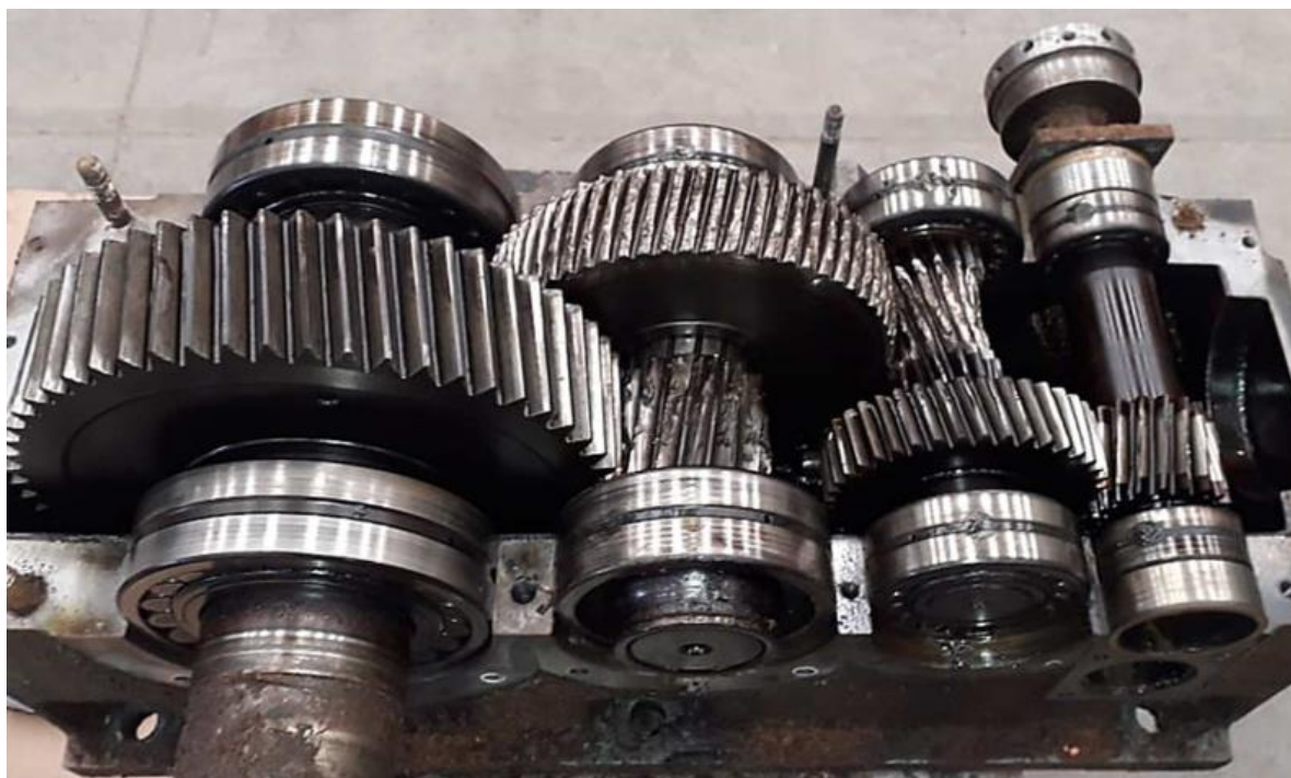
Figura 19 - Redutor de equipamento crítico inutilizado
