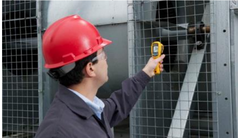
Figura 5 - Verificação de temperatura com termômetro infravermelho
