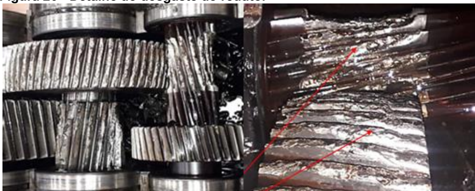
Figura 20 - Detalhe do desgaste do redutor
