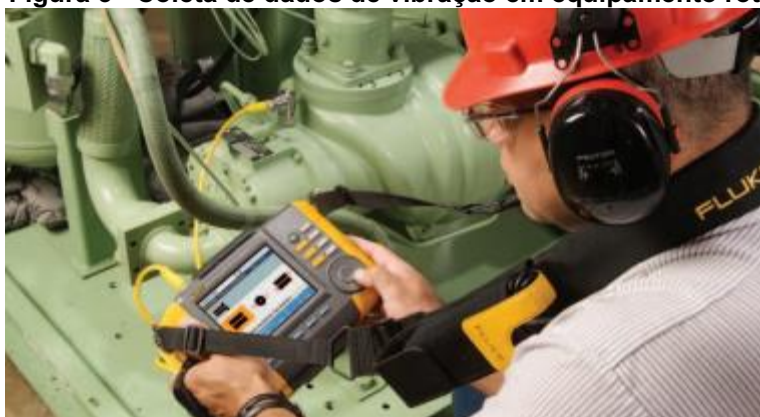
Figura 3 - Coleta de dados de vibração em equipamento rotativo
