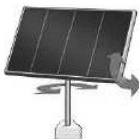
Figura 10 - Rastreador com movimentação nos dois eixos
