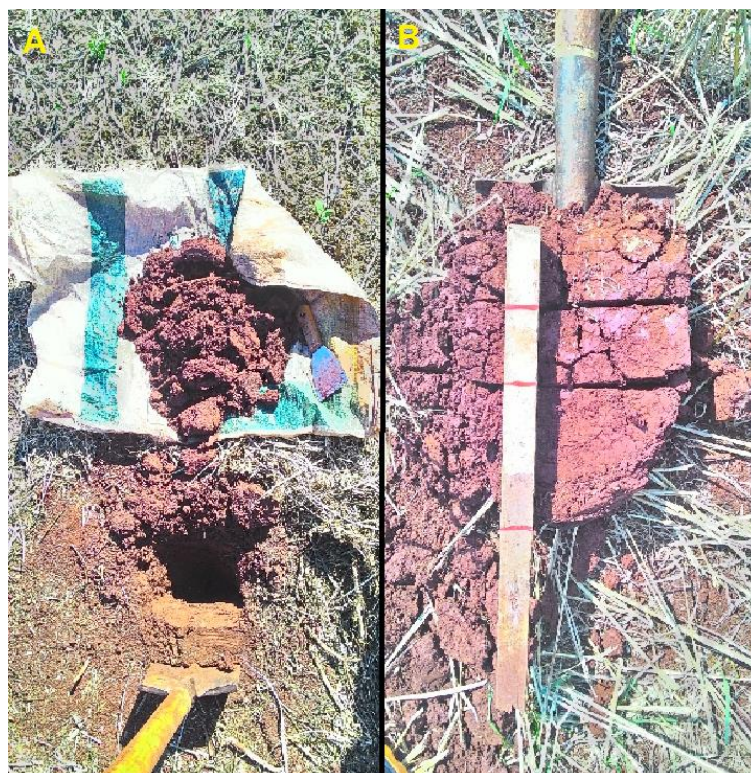
Figura 4: a) abertura de trincheira para coleta de solo. b) Delimitação das camadas do solo 0 a 5, 5 a 10 e 10 a 20 cm.
