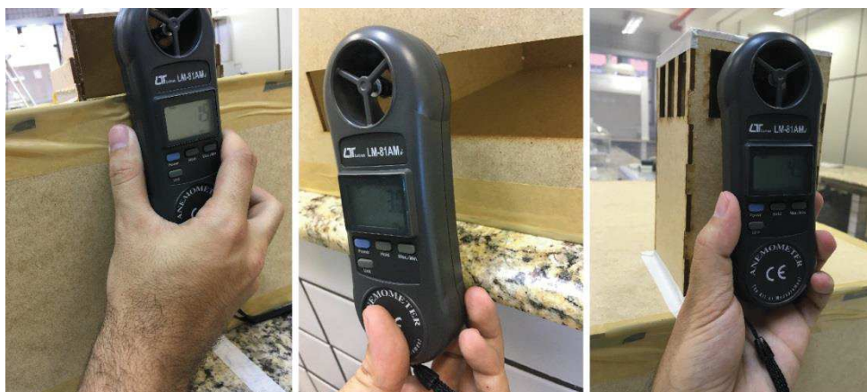
Figura 44 - Uso do anemômetro para controle da velocidade dos testes.
