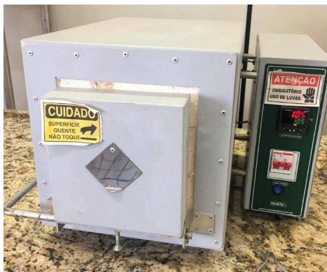
Figura 27 – Forno mufla utilizado no aquecimento dos corpos de prova a 105°C.
