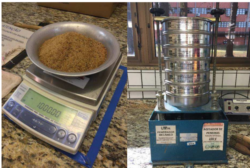
Figura 9 – Ensaio de granulometria da areia.
