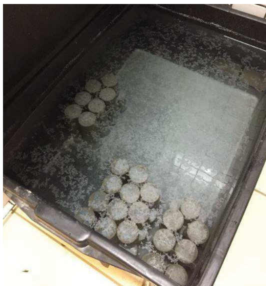
Figura 24 – Tanque utilizado no processo de cura e corpos de prova imersos em água.
