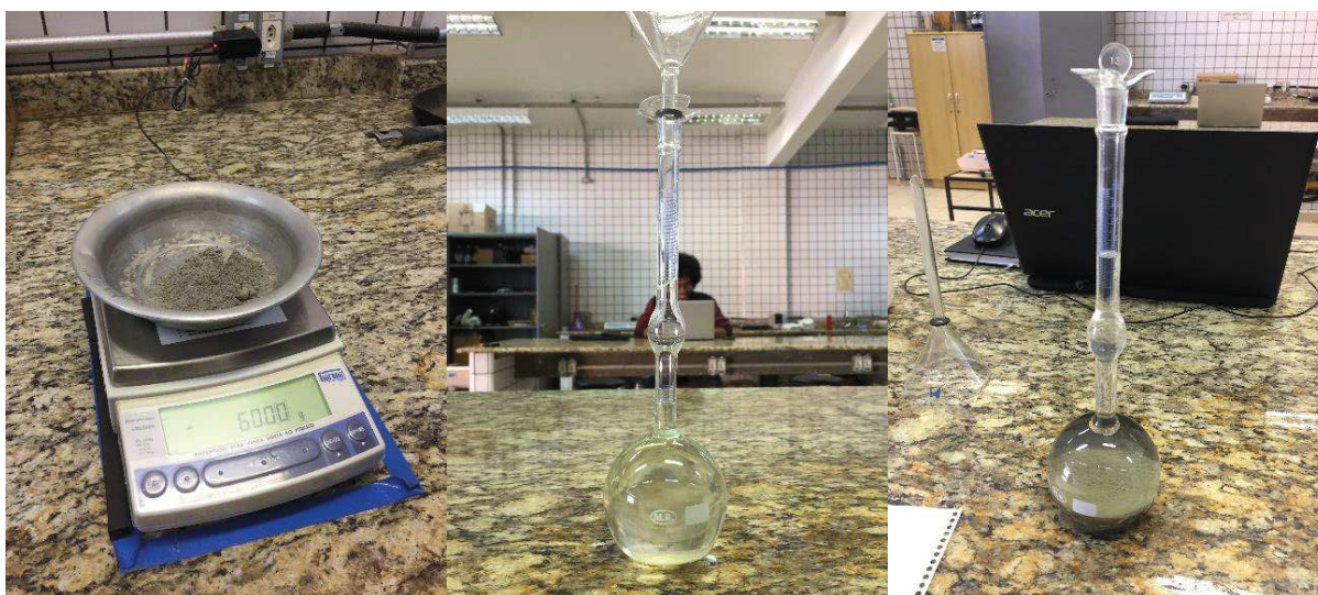
Figura 11 – Ensaio de determinação da massa específica do cimento.
