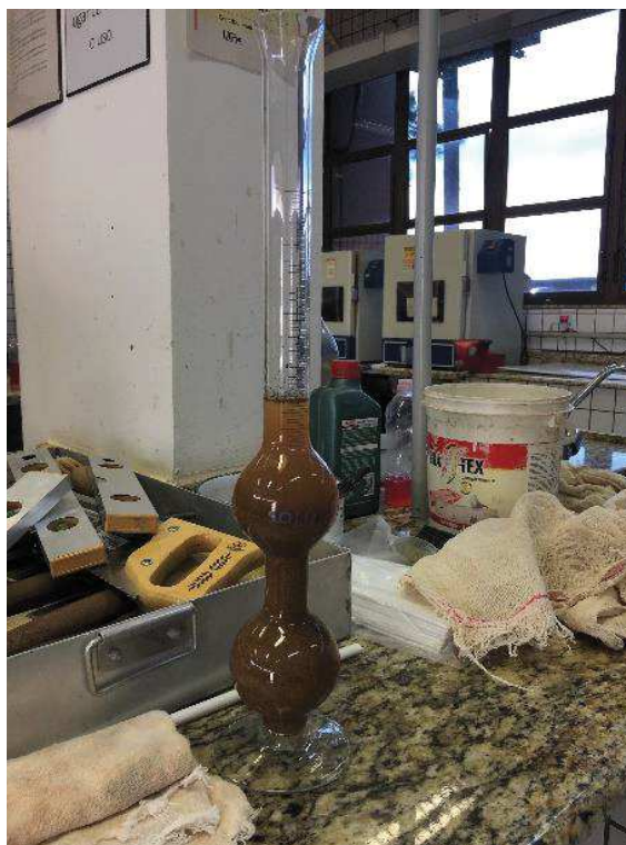
Figura 12 – Ensaio de determinação da massa específica do agregado miúdo.
