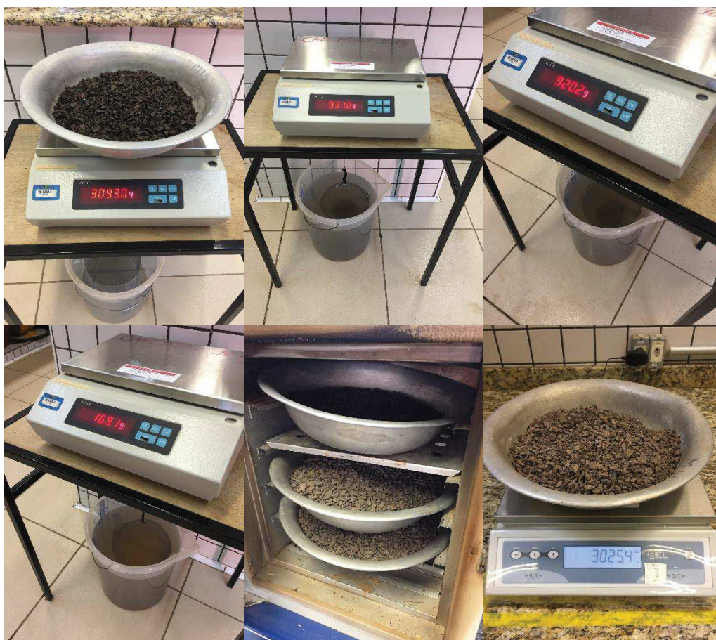
Figura 13 – Ensaio de determinação da massa específica da brita.
