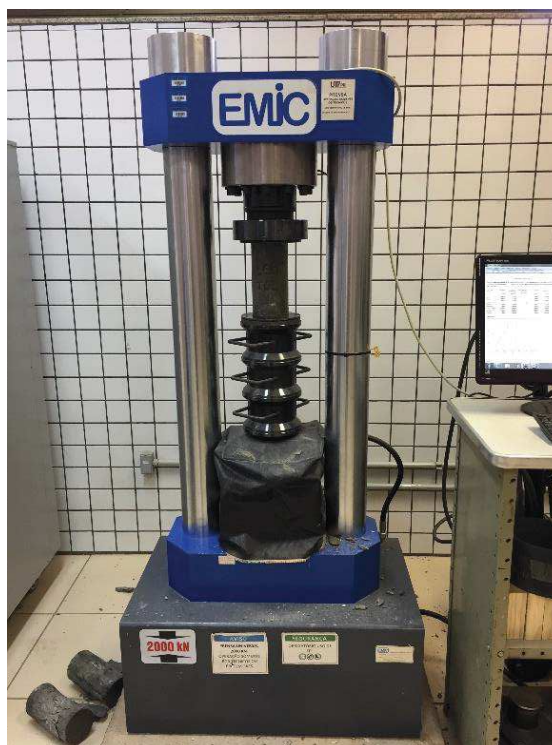
Figura 21 – Prensa de Compressão EMIC AC6.08.
