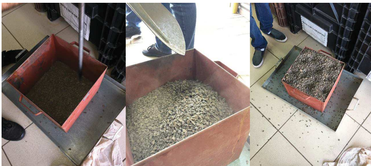
Figura 14 – Ensaio de determinação da massa unitária compactada da brita.
