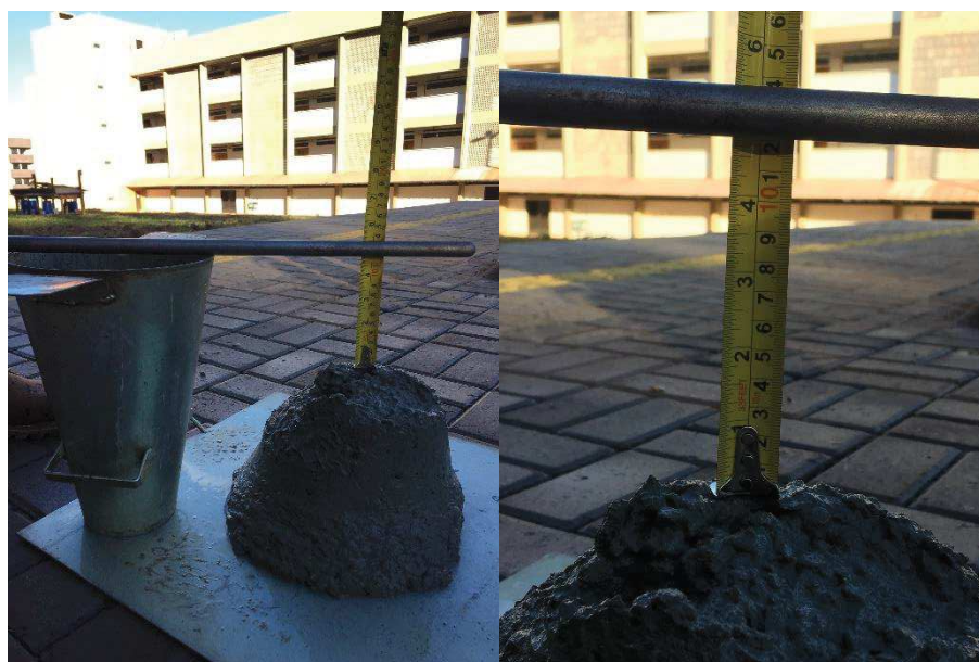
Figura 16 – Medição do abatimento de tronco de cone.
