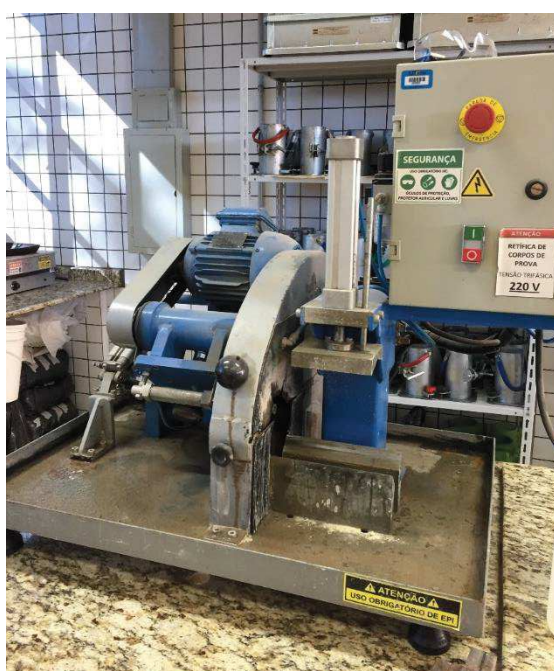
Figura 20 – Máquina utilizada para retificação dos corpos de prova.
