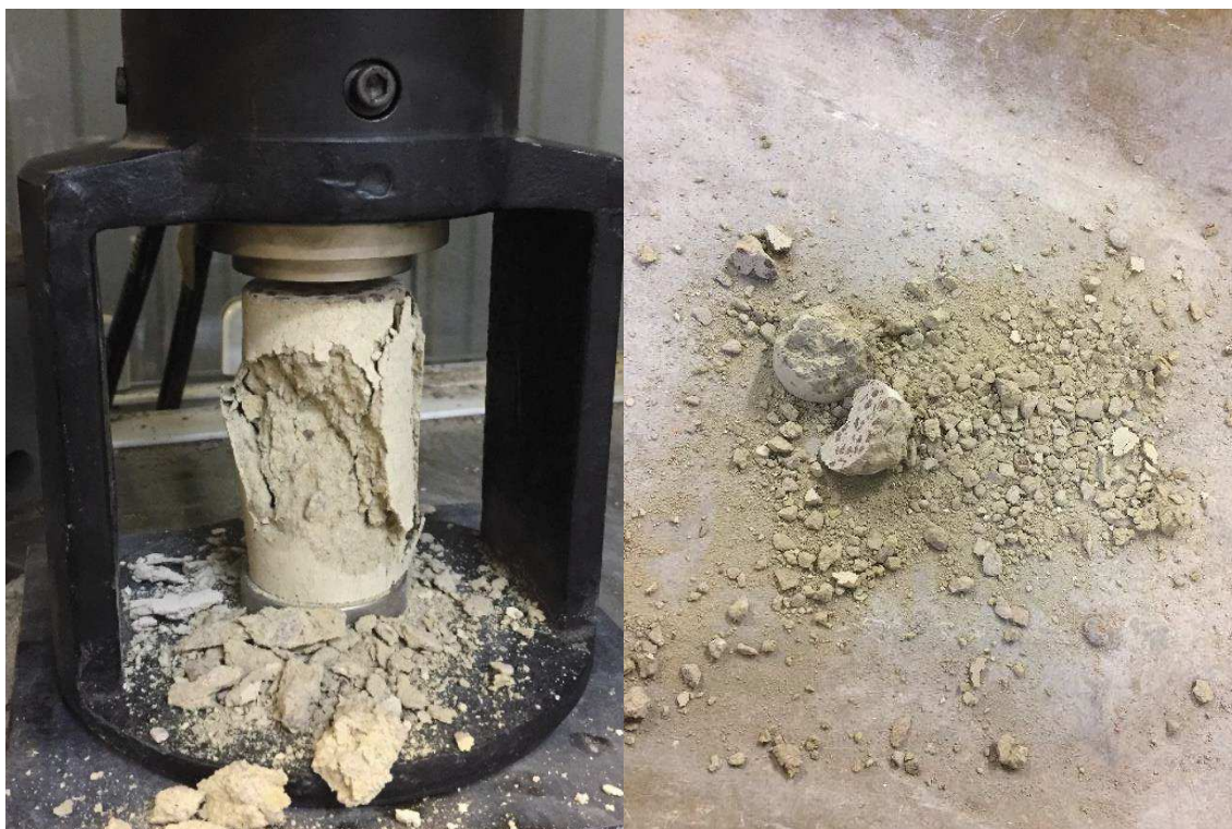
Figura 43 – Ensaio de compressão após exposição a 1000°C com resfriamento natural.
