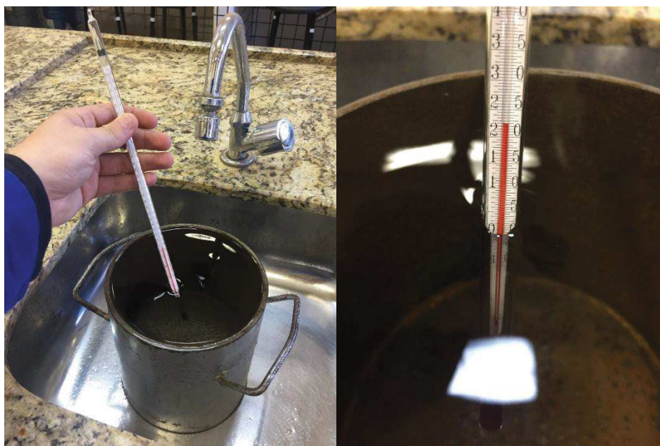
Figura 30 – Medição da temperatura da água no momento do resfriamento brusco.
