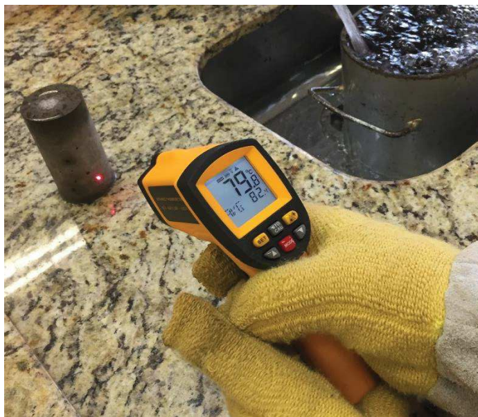
Figura 32 – Medição da temperatura superficial do corpo de prova após resfriamento brusco.
