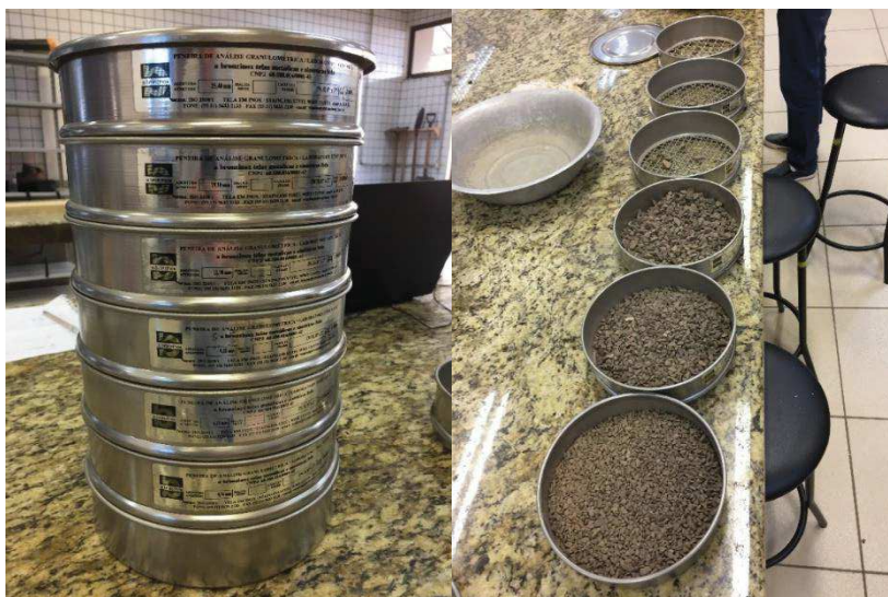
Figura 10 – Ensaio de granulometria da brita.
