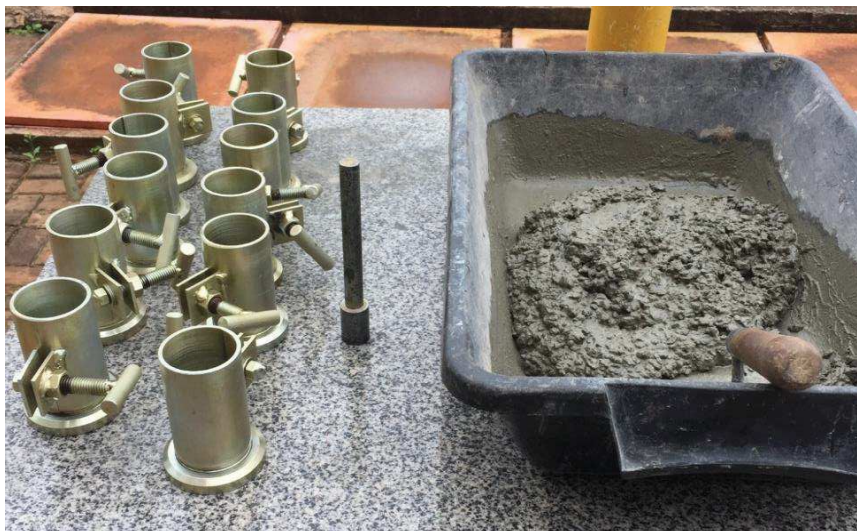
Figura 22 – Equipamentos e material utilizados na moldagem dos corpos de prova.
