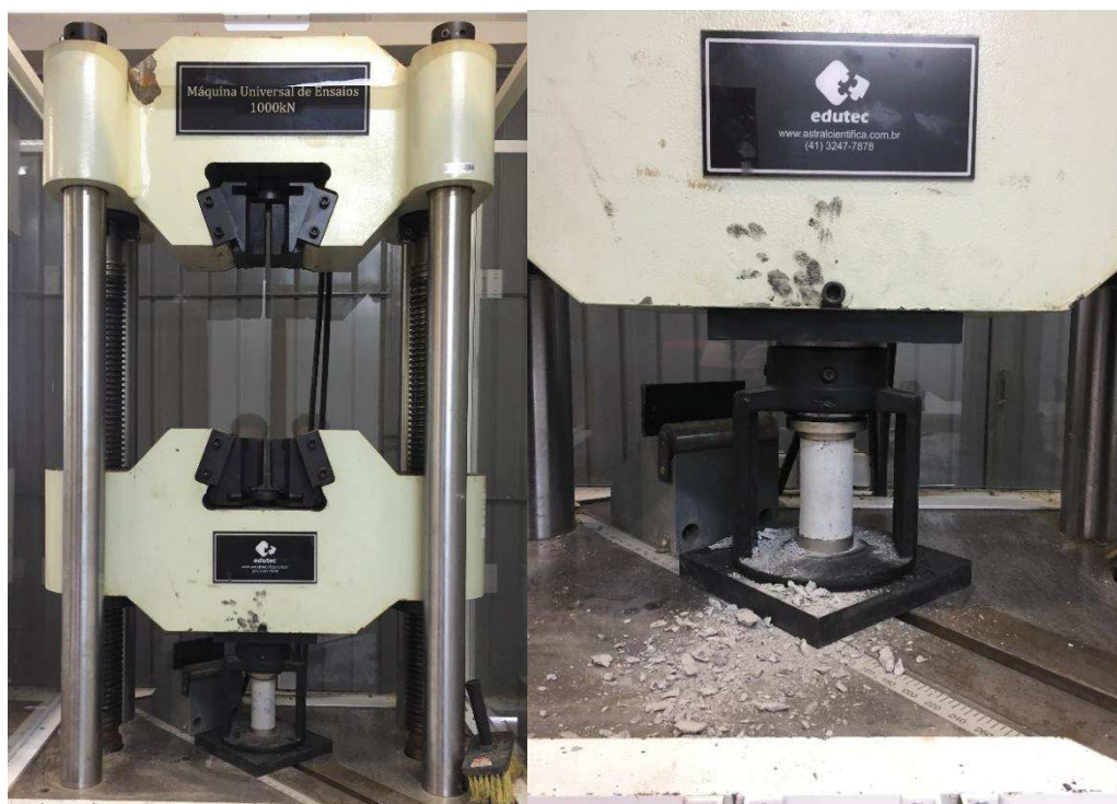
Figura 33 – Máquina para Teste Universal WAW-1000D.
