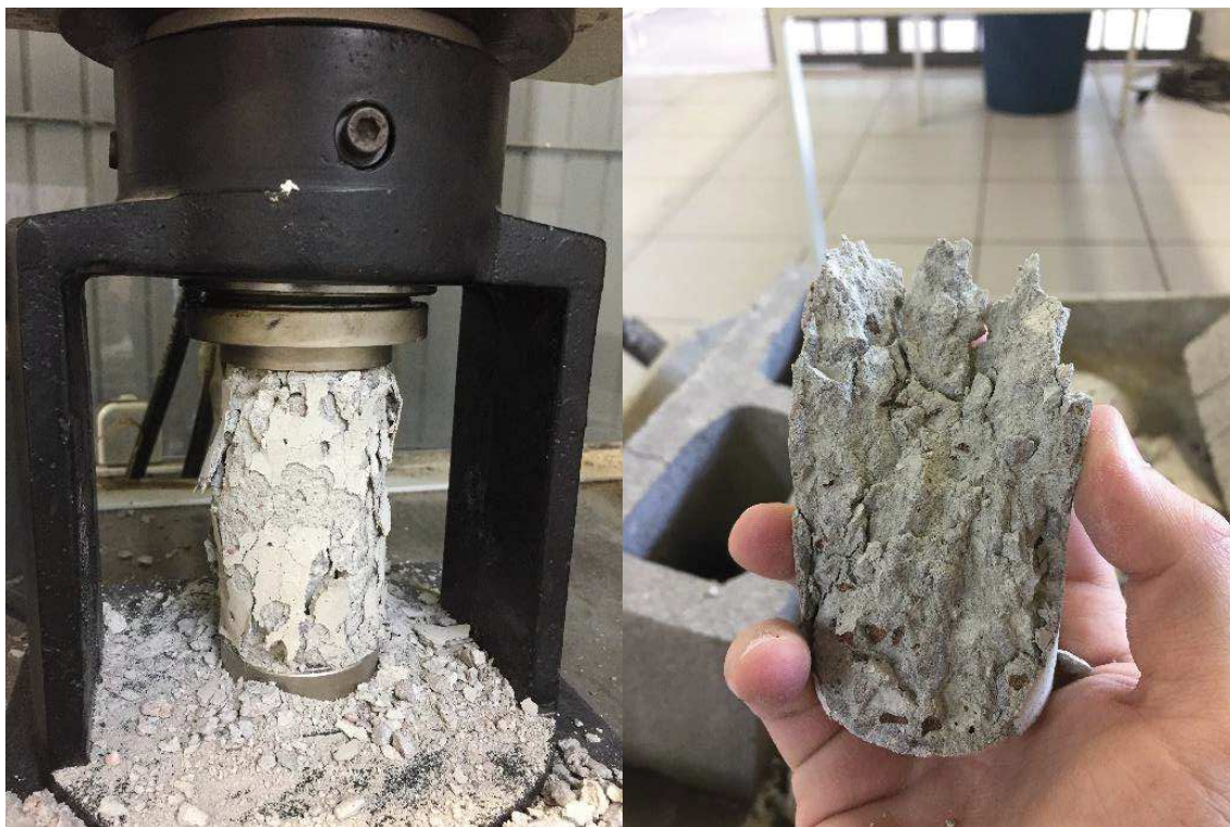
Figura 42 – Ensaio de compressão após exposição a 800°C com resfriamento brusco.
