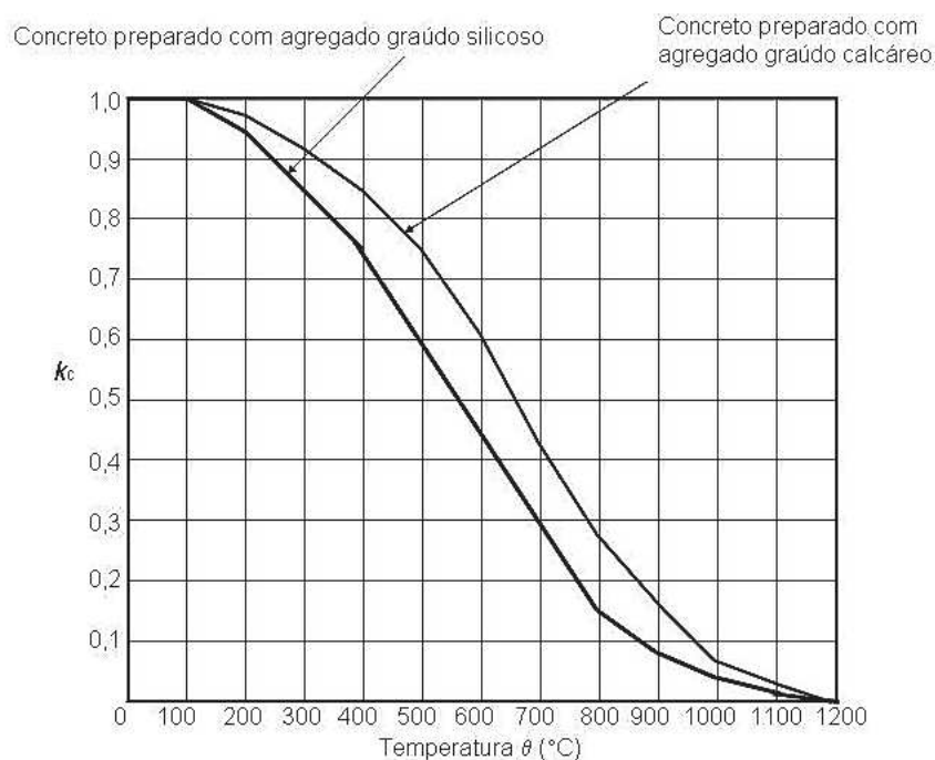
Figura 4 – Fator de redução da resistência do concreto em função da temperatura.
