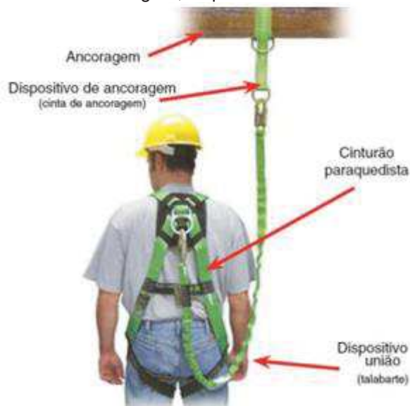
FIGURA 10– Sistema de ancoragem, dispositivo de união e cinturão paraquedista
