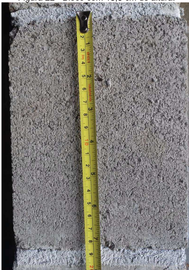
Figura 22 - Bloco com 18,5 cm de altura.
