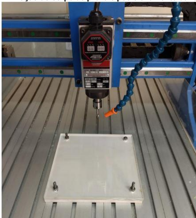
Figura 11. Fixação do corpo de prova e posicionamento da ferramenta
