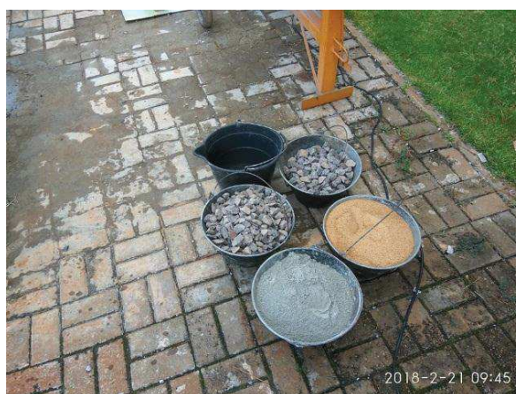
Figura 24 – Materiais utilizados para a elaboração do concreto com brita 2 Fonte: Autor
