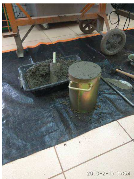
Figura 14 – Preparação da amostra de concreto conforme NBR 9833 Fonte: Autor
