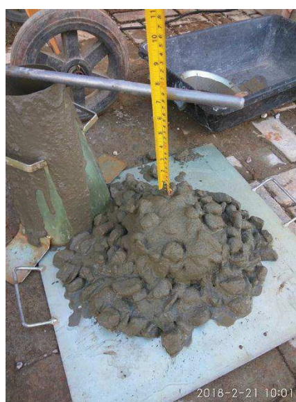
Figura 27 – Slump Test, abatimento realizado com concreto de brita 2 conforme a norma NBR NM 67 Fonte: Autor
