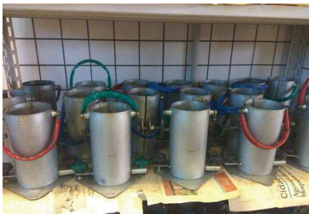
Figura 21 – Moldes metálicos a serem utilizados para confecção dos corpos de prova Fonte: Autor
