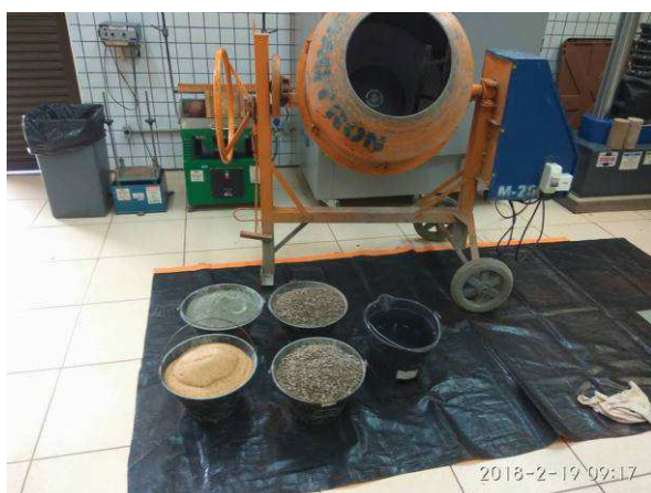
Figura 23 – Materiais utilizados para a elaboração do concreto com brita 0 Fonte: Autor
