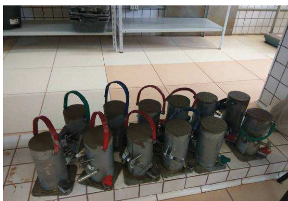
Figura 25 – Corpos de prova de concreto moldados de acordo com a NBR 5738 Fonte: Autor
