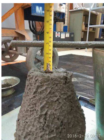
Figura 26 – Slump Test, abatimento realizado com concreto de brita 0 conforme a norma NBR NM 67 Fonte: Autor
