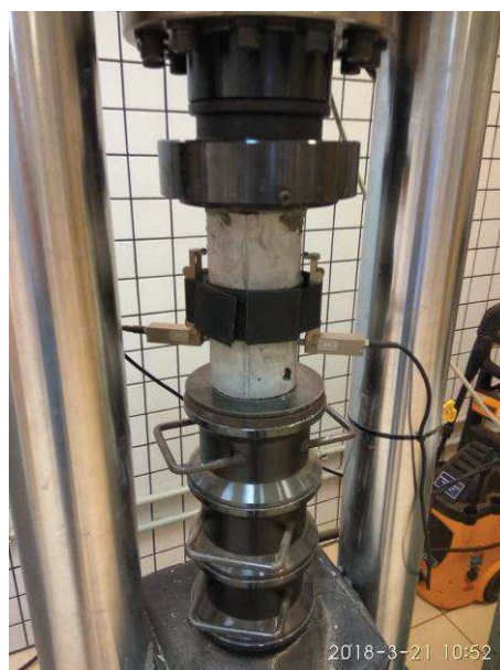
Figura 20 – Análise do Módulo de elasticidade estático dos concretos Fonte: Autor
