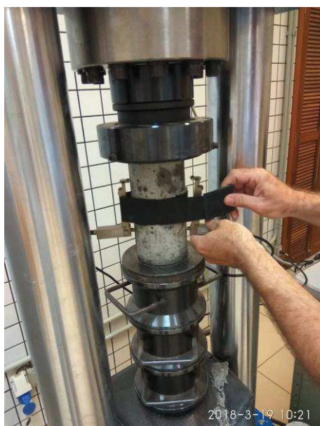
Figura 19 – Instalação dos medidores de deformação para os concretos Fonte: Autor
