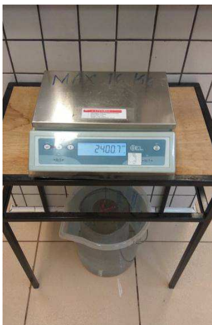
Figura 16 – Determinação da massa imersa do concreto endurecido, conforme NBR 9778 Fonte: Autor
