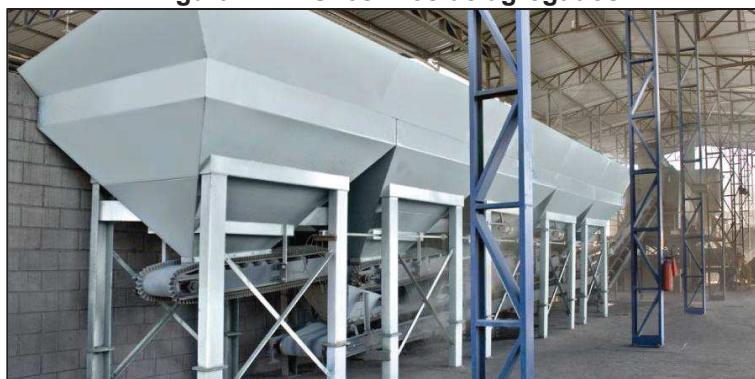
Figura 27 — Silos frios de agregados
