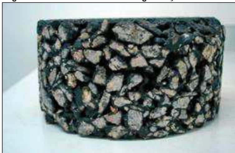
Figura 5 — Amostra de mistura de graduação aberta - CPA
