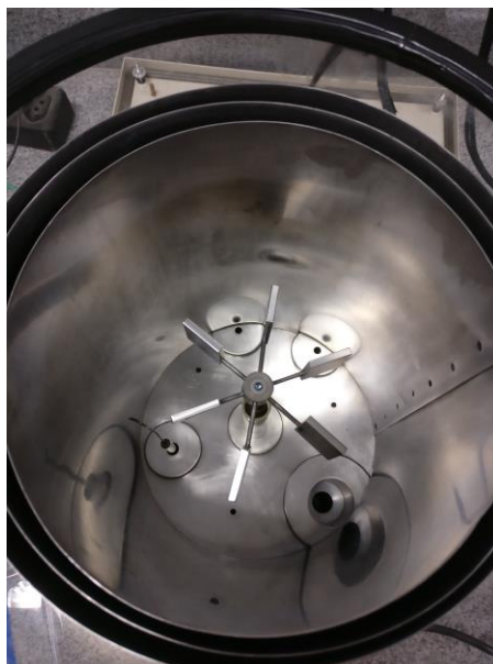
Figura 19 - Câmara de nitretação do reator de parede fria da UTFPR com amostras alojadas no suporte.
