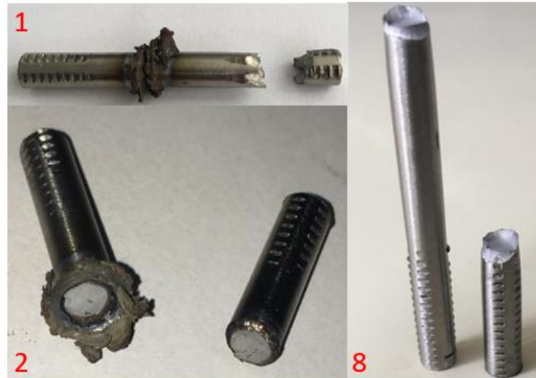
Figura 38 – Fratura das amostras 1, 2 e 8 (não soldada).
