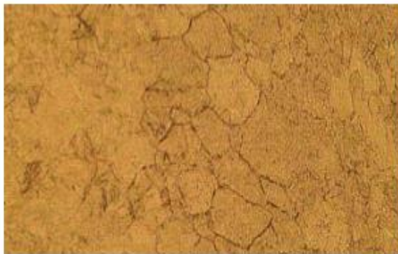
Figura 12 - Junta soldada por RFW convencional 1500 rpm (aumento maior que 200x).
