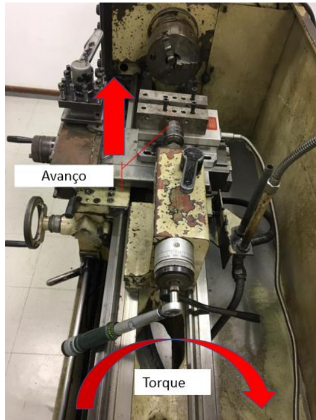
Figura 32 – Vista superior do ensaio para medição da força axial.
