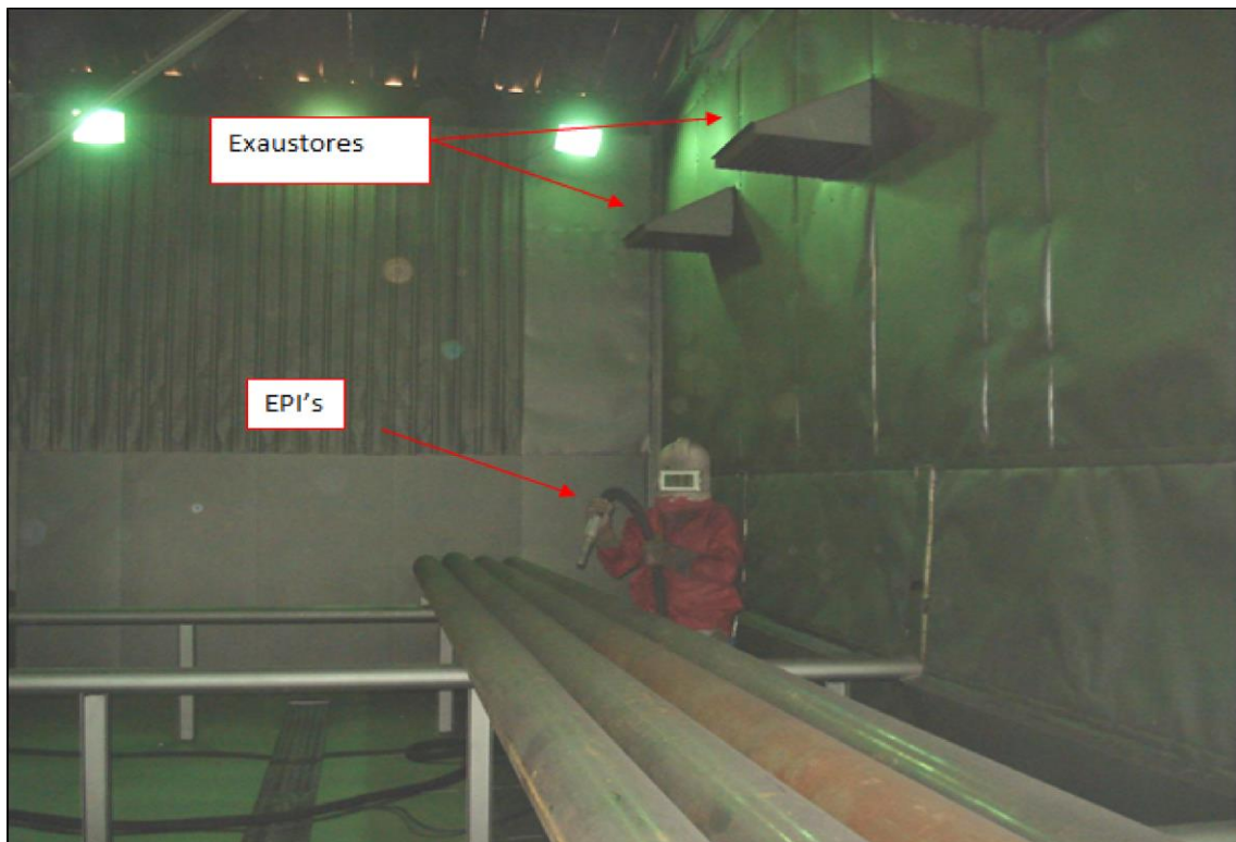
Figura 18 - Exaustores e EPI's
