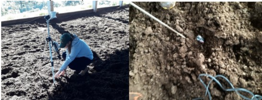
Figura 10 - Mensuração da temperatura e umidade interna da cama.
