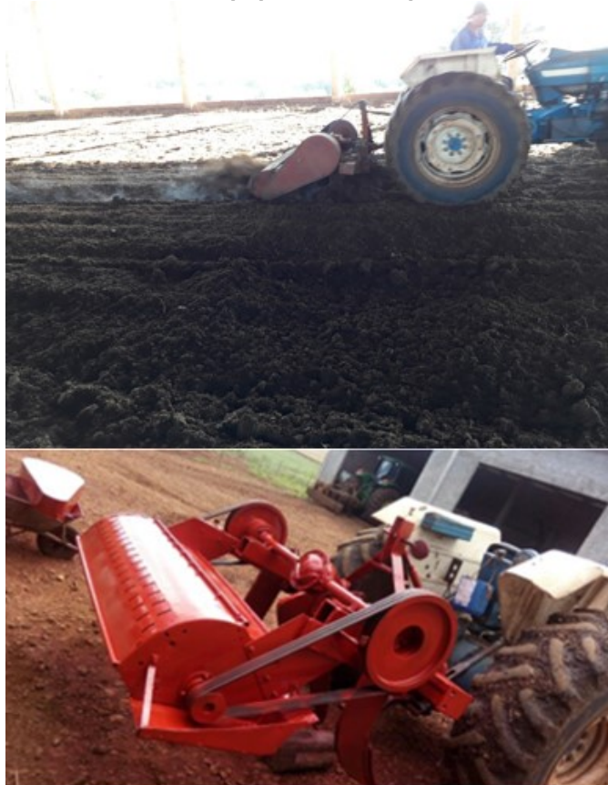
Figura 5 – Revolvimento da cama com equipamento adaptado.
