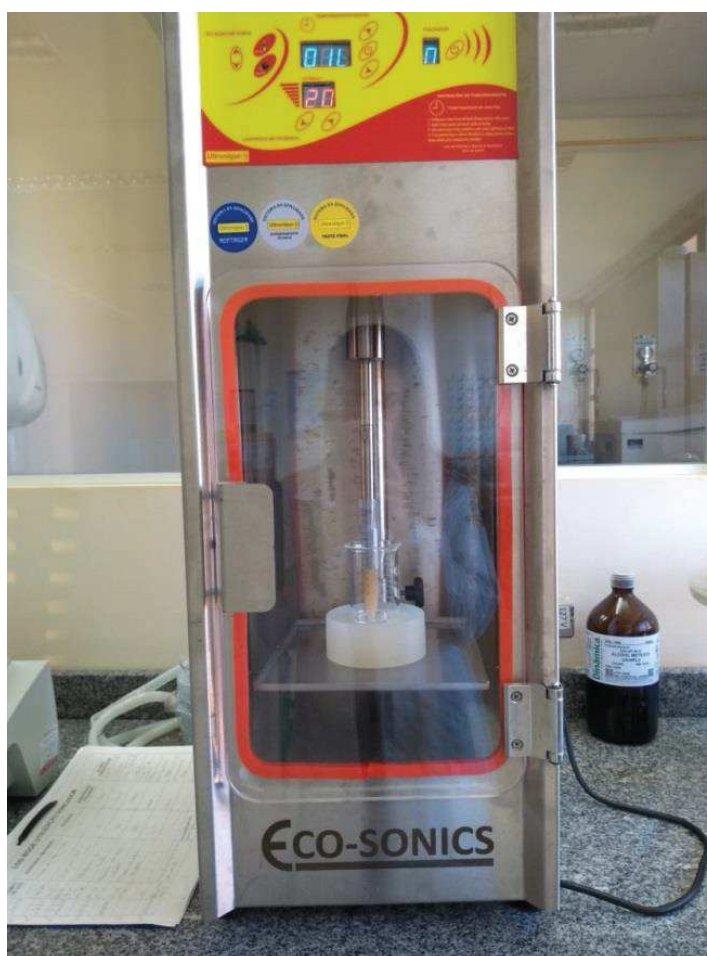
Figura 14- Extração em sonicador de probeira ultrassônica.
