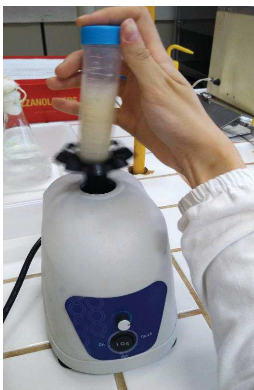
Figura 13- Extração com pérolas de vidro agitadas em vórtex.
