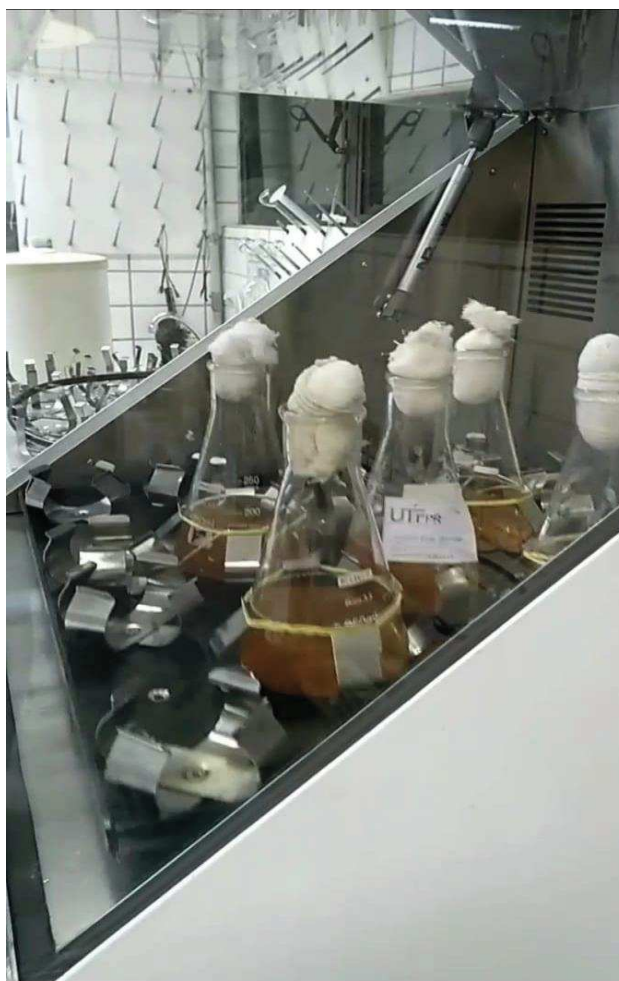
Figura 12- Fermentação submersa em incubadora de agitação e temperatura controlada.
