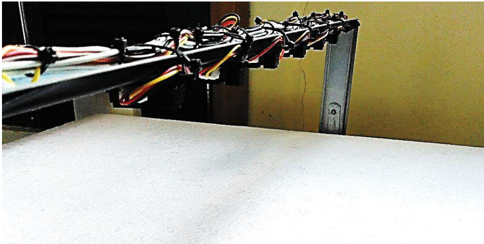
Figura 17. Metodologia de levantamento de pontos da equação da curva dos sensores infravermelhos. Fonte: Autor.
