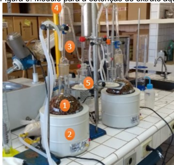
Figura 6: Módulo para a obtenção do extrato aquoso da casca de laranja.
