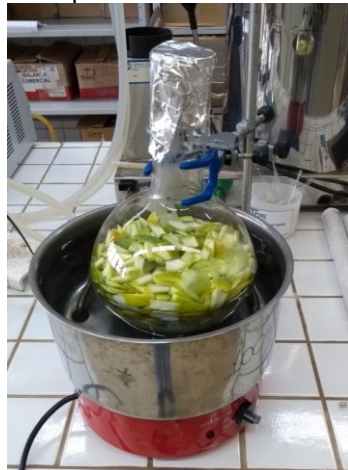
Figura 7: Tratamento pré-enzimático da matéria-prima vegetal
