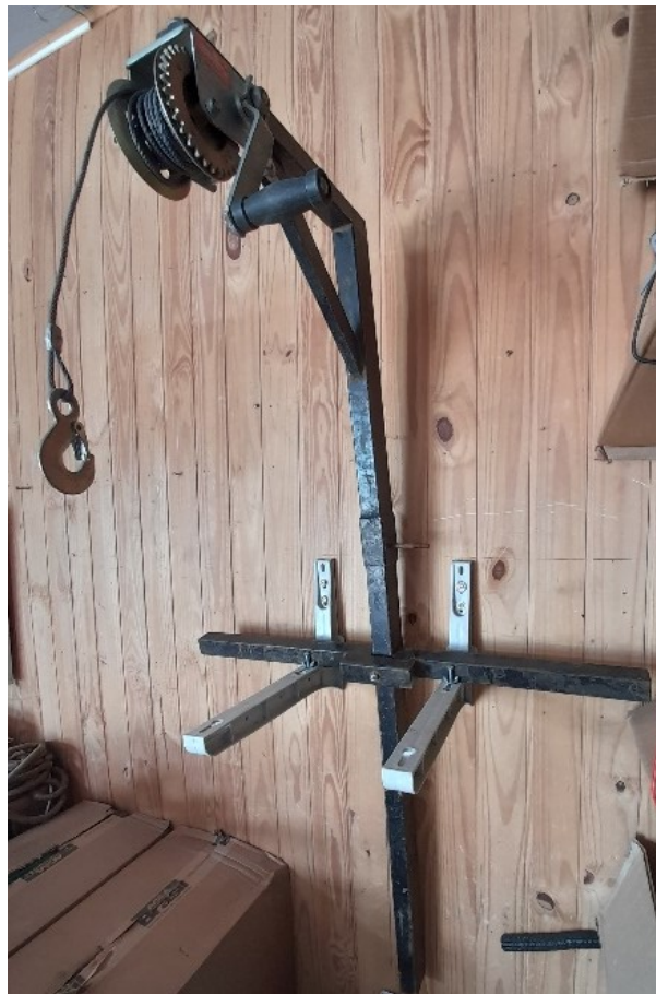
Figura 4 - Içador de ar condicionado
